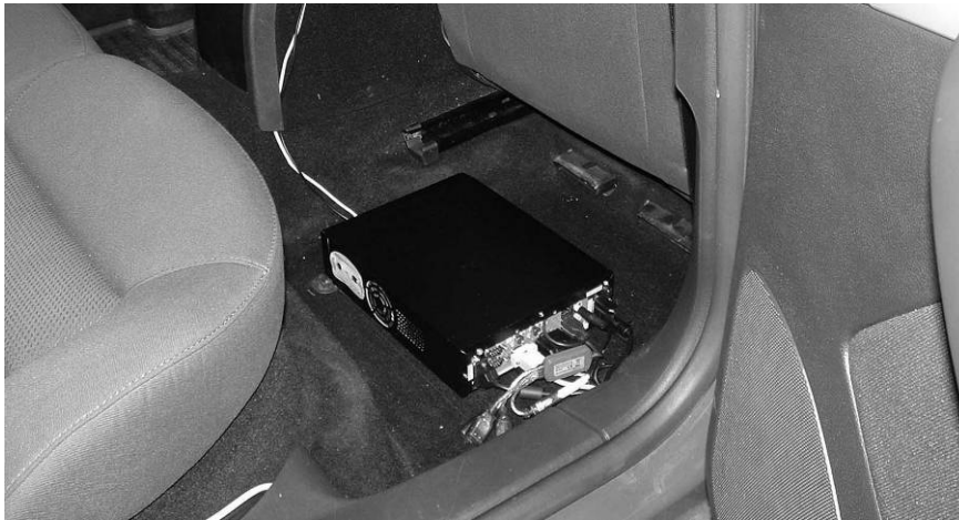
Abb. 3 BlackBox computer unter dem Beifahrersitz
