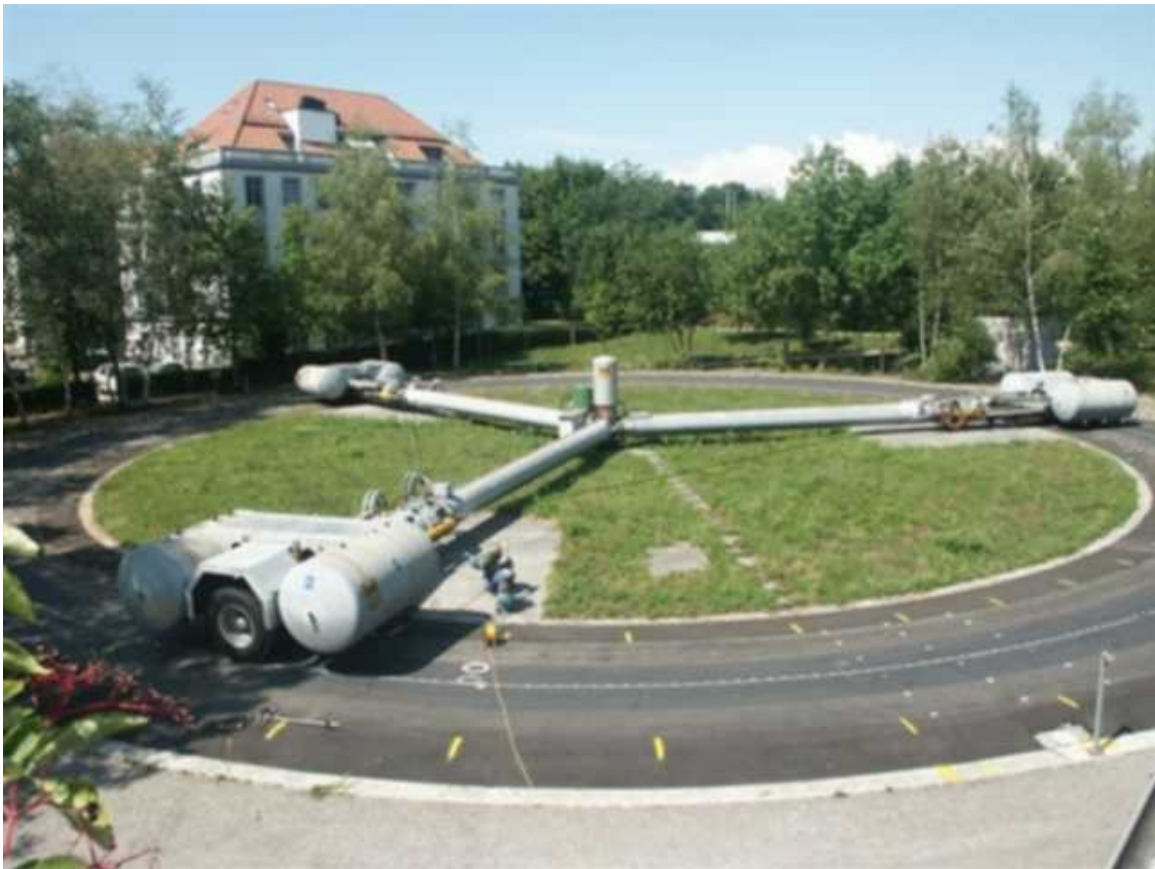
Bild 11 : Messpunkte der Längsebenheit (weiss, in der Mitte der Fahrbahn)
