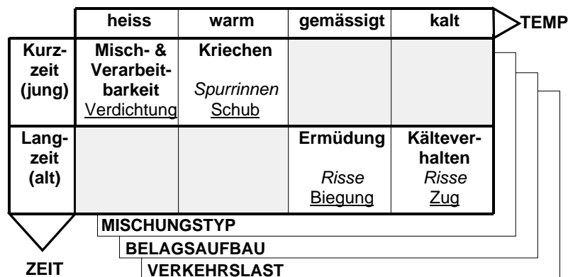
Abbildung 0.1 Zeit-Temperatur Matrix mit Risikobereichen in Abhängigkeit von Mischungstyp, Belagsaufbau und Verkehrslast (Schäden, Beanspruchungen ).
