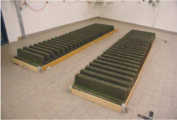
Ansicht: Verlegung der absorbierenden Beton-Elemente auf dem Hallraumboden (ohne Stützeinfluss)
