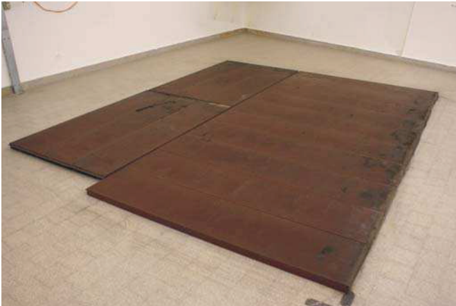
Ansicht: Verlegung der absorbierenden Verkleidung mit Alu-Blechen auf dem Hallraumboden
