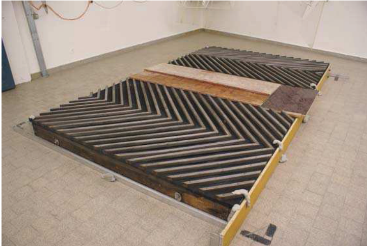
Ansicht: Verlegung zweier Holz-Elemente auf dem Hallraumboden; Einspannbereich der Elemente (ohne Diagonallattung) mit reflektierenden Schalplatten abgedeckt (ohne Berücksichtigung bei der Prüffläche)
