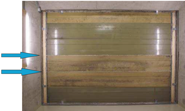
Ansicht: Rückseite im Wandprüfstand Alu- Kassetten stehend horizontal verlegt Horizontalschlitz hier noch geschlossen
