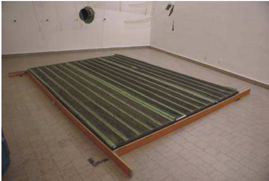
Ansicht: Verlegung der Alu-Kassetten auf dem Hallraumboden (ohne Stützeinfluss)
