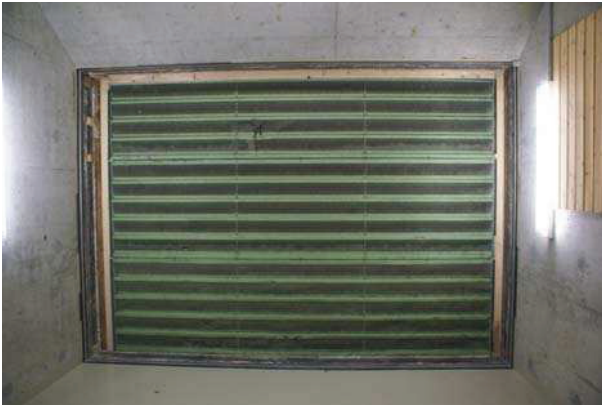
Ansicht: absorbierende Seite im Wandprüfstand Alu-Kassetten stehend horizontal verlegt
