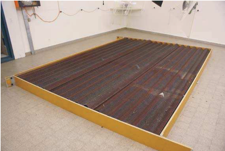
Ansicht-Detail: vorderseitig Alu-Wellplatte mit Rundlochung Ø 10 mm Lochanteil ca. 45 %
