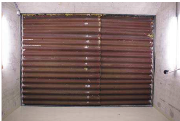
Ansicht: reflektierende Seite im Wandprüfstand AZ-Wellplatten stehend mit Überlappung horizontal verlegt; Defektstellen provisorisch verschlossen
