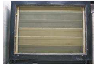
Ansicht: Lärmschutzwand mit Alu-Kassetten eingebaut im Wandprüfstand
