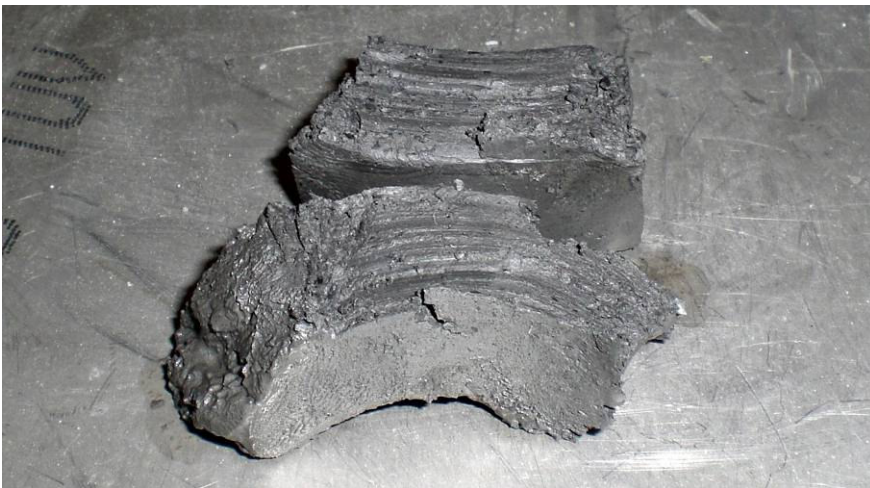
Bild 33: Deutlich ausgebildete Scherfläche, Probe 2 < 2mm (Villiger, 2008)
