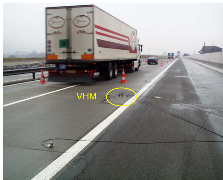
Abbildung 7.3.2: Anordnung der Messstelle 2 auf der Autobahn VHM Messung der relativen Horizontal- und Vertikalbewegungen der Betonfahrbahnplatten
