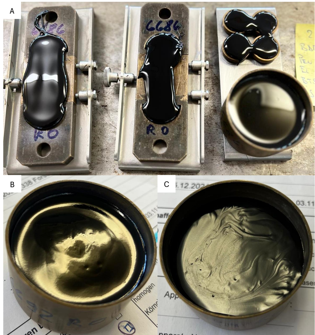
Abbildung 7: PmBs, die nach der Rückgewinnung bei 145 °C nicht weiter erhitzt wurden. (A) PmB 25/55-80 von Hersteller 3. Das PmB war sehr dickflüssig und die Prüfgefäße schwer zu befüllen. (B) PmB 90/150-80 von Hersteller 4. Homogenisierung nicht möglich. (C) PmB-E 25/55-65 von Hersteller 5. Unregelmässige Oberfläche. Siehe auch Tabelle 12
