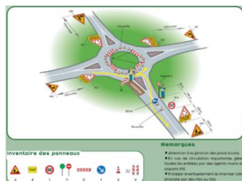
Figure 82: Travaux sur giratoire, sortie neutralisée.
