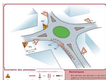
Figure 77: Travaux sur giratoire sur voie de sortie (voie de droite).
