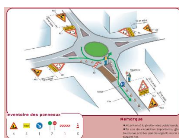
Figure 79: Travaux sur giratoire neutralisant une sortie.
