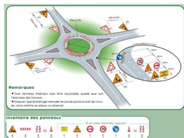
Figure 80: Travaux sur giratoire, neutralisation de l'intérieur de l'anneau.
