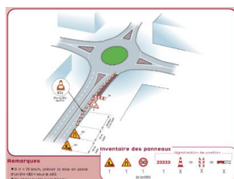
Figure 75: Travaux sur giratoire sur voie d'entrée (voie de droite).
