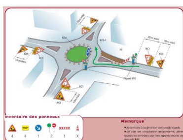
Figure 78: Travaux sur giratoire neutralisant une entrée.
