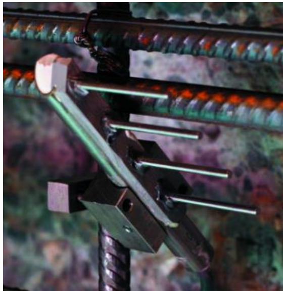
Abbildung 25: Leiterförmiger Betonwiderstandssensor CS-402 der TFB Diagnostic Systems AG
