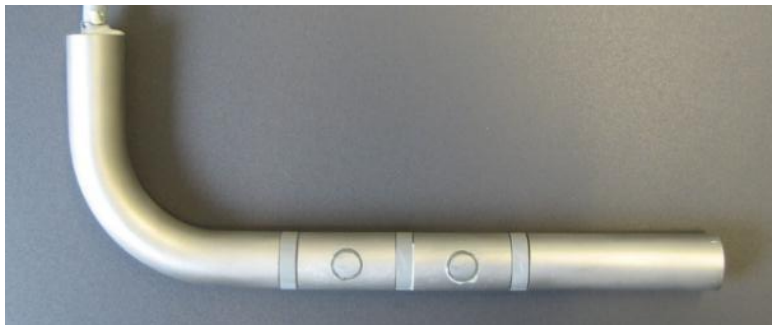
Abbildung 15: Kombiniertes Korrosionsstrom- und Widerstandssensor des Typs CS-322 der TFB Diagnostic Systems AG
