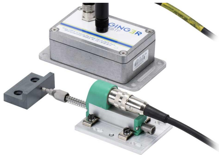
Abbildung 28: Rissaufnehmer mit linearpotentiometrischem Wegaufnehmer (Bild Ginger CEBTP)
