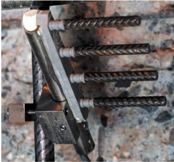
Abbildung 14: Betonstahlsensoren des Typs CS-040 der TFB Diagnostic Systems AG
