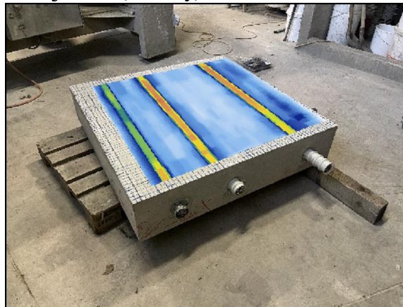
Abbildung 26: Ultraschall-Ergebnisdarstellung für Prüfkörper Uno bei Messung von der Rückseite.
