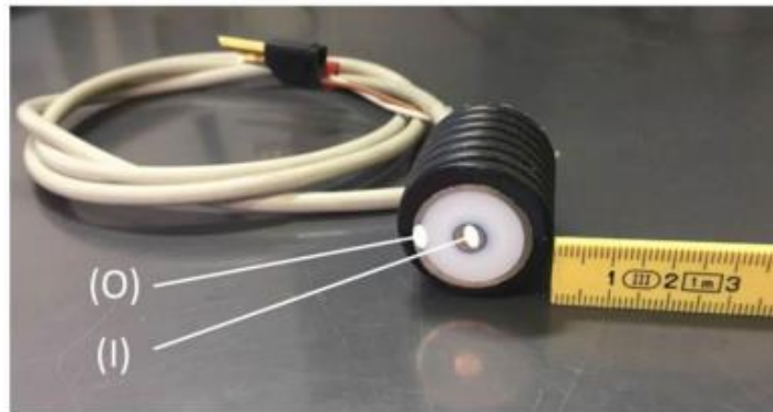
Abbildung 8: VCsensor von VSL zur Qualitätsüberwachung des Füllguts, aus [15]
