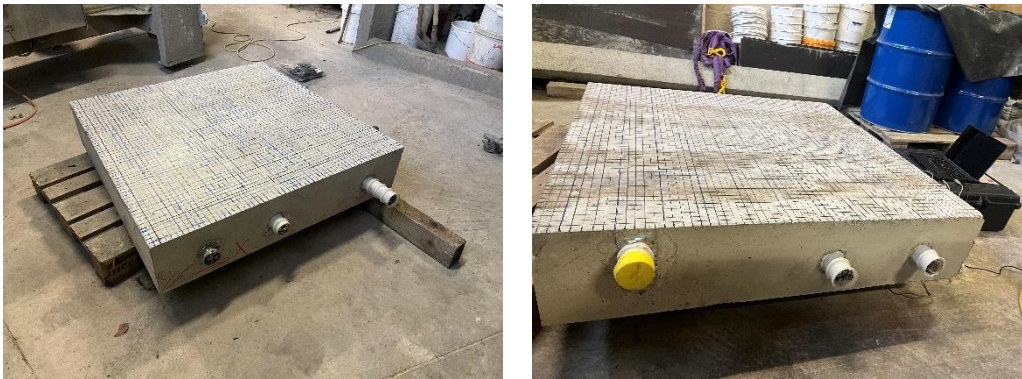
Abbildung 21: Prüfkörper Uno (links) und Dos (rechts) mit angezeichneten Messrastern von 2 x 2 cm.
