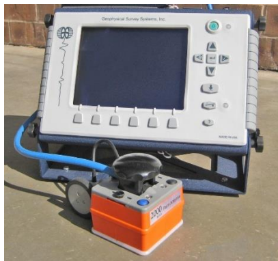
Abbildung 14: Radar-System-1 bestehend aus Datenerfassungseinheit SIR 3000 und Palm-Antenne der Firma GSSI.
