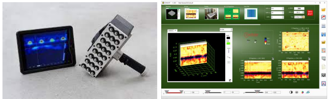
Abbildung 10: Ultraschall-System-1 bestehend aus Gerät Pundit 250 Pro Array (links) und Analysesoftware ECHOLYST (rechts).
