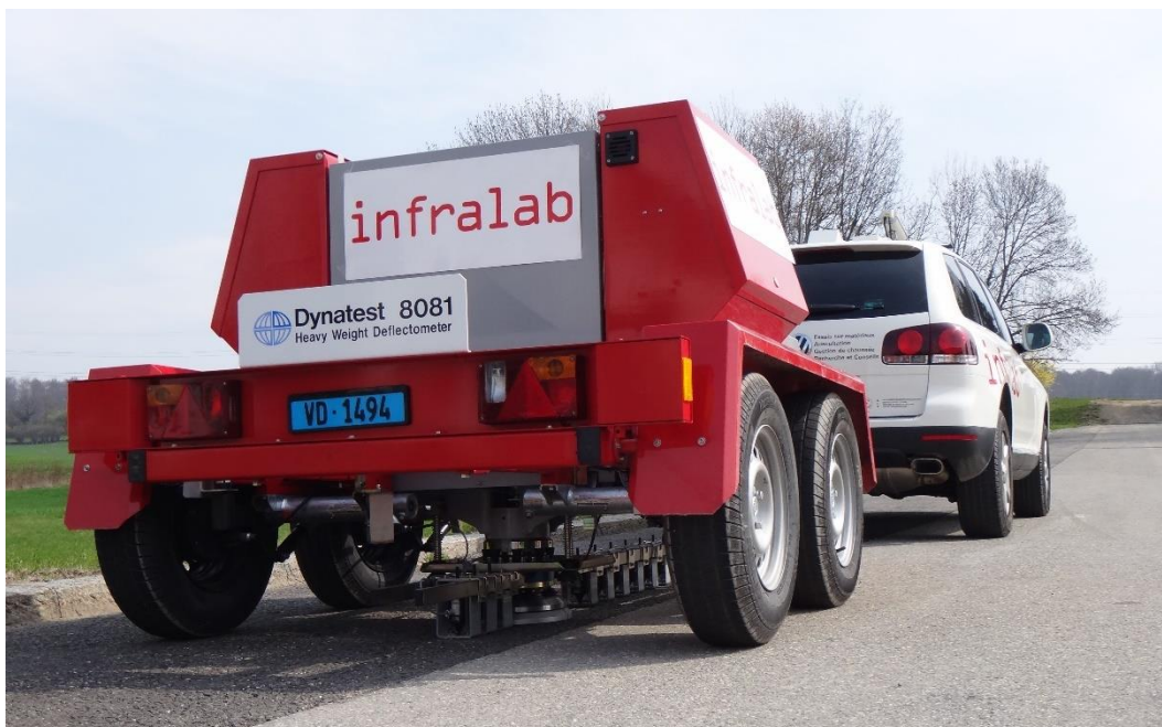
Figure 25 : Photo de l'appareil de mesure HWD utilisé pour ces mesures
