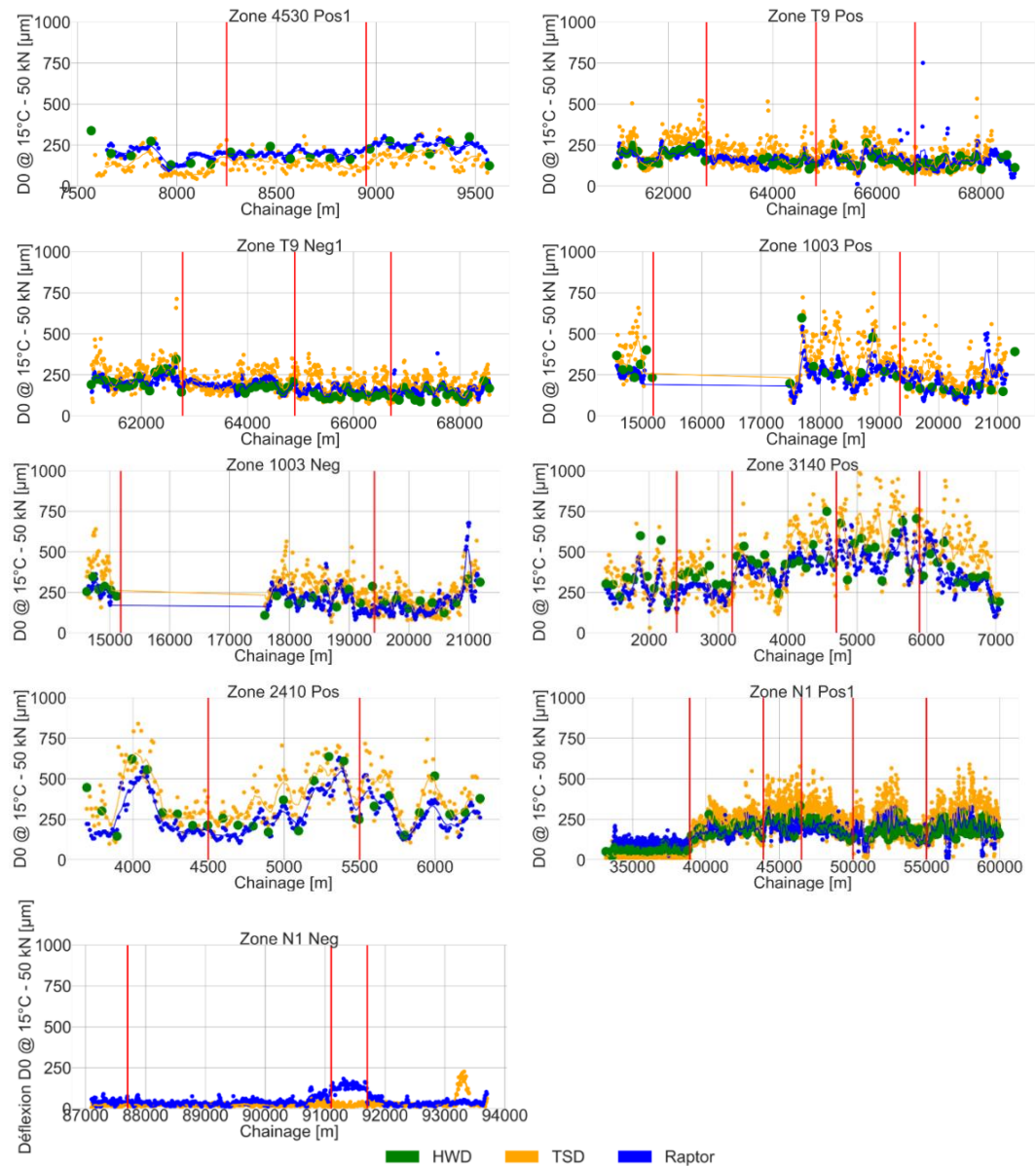
Figure 80 : Comparaison des déflexions D0 corrigées à 15°C et 50 kN enregistrées par les trois appareils
