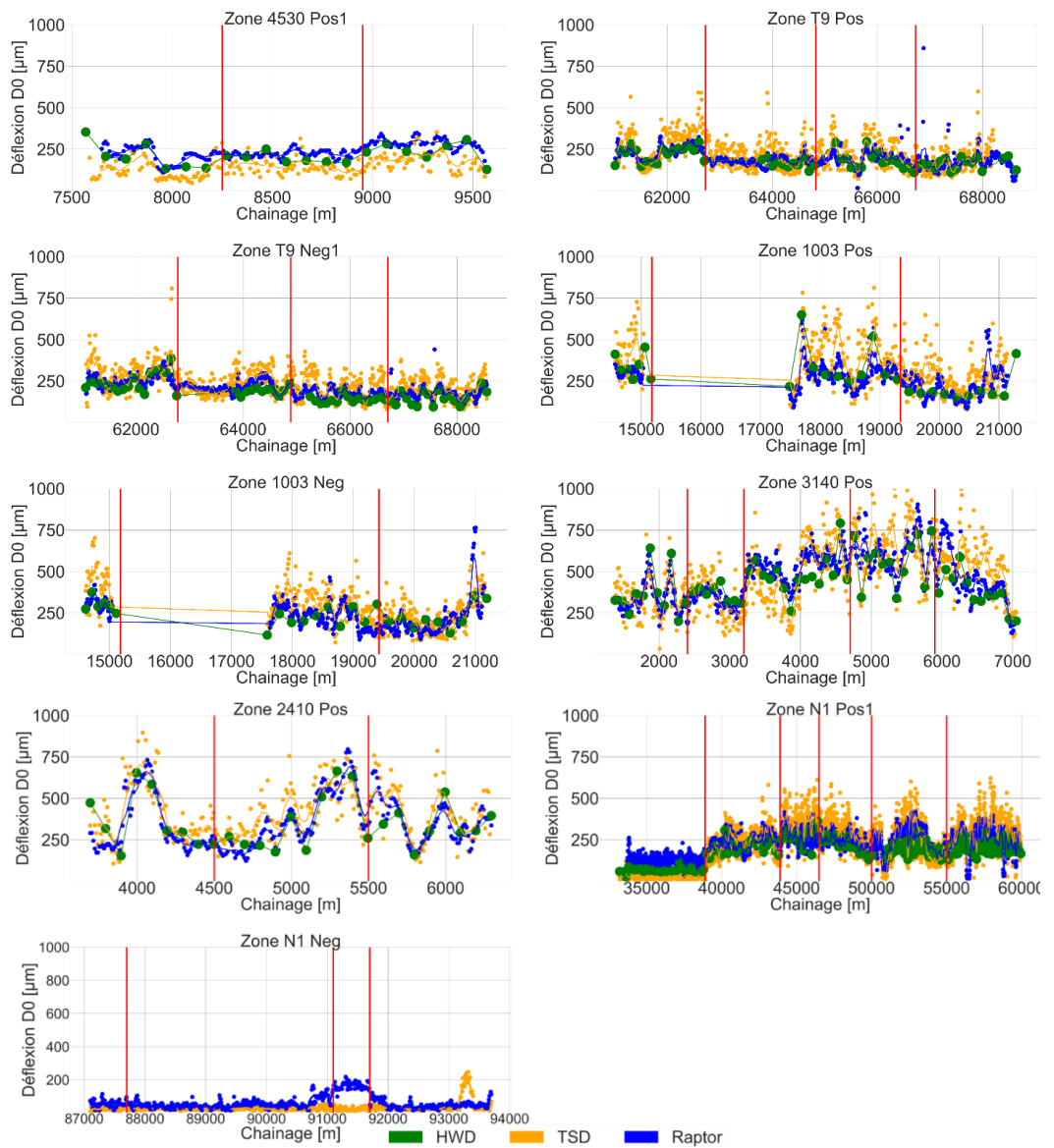
Figure 67 : Comparaison des déflexions D0 corrigées en fonction la charge appliquée
