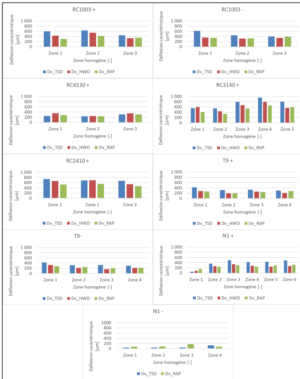
Figure 90 : Comparaison des déflexions caractéristiques @ 15°C – 50 kN
