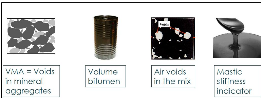
Abbildung 4: Spezifische Indikatoren, die für die Schätzung der Leistung von Asphaltgemischen erforderlich sind (Quelle: BRRC)
