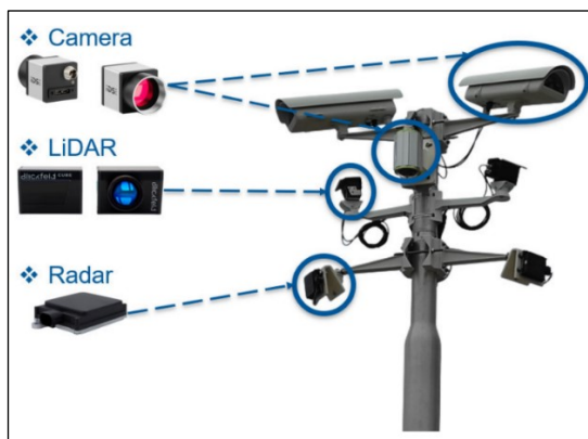
Abbildung 16: Eine Illustration des Sensoreinsatzes am Mast [113].
