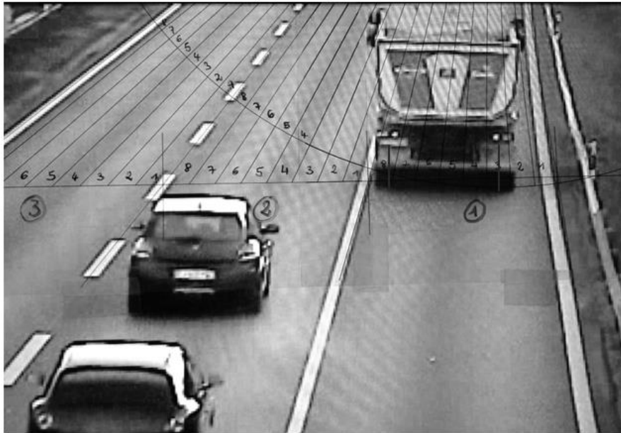
Fig. 65 Traitements de l'image et mesure par deux cas extrêmes.
