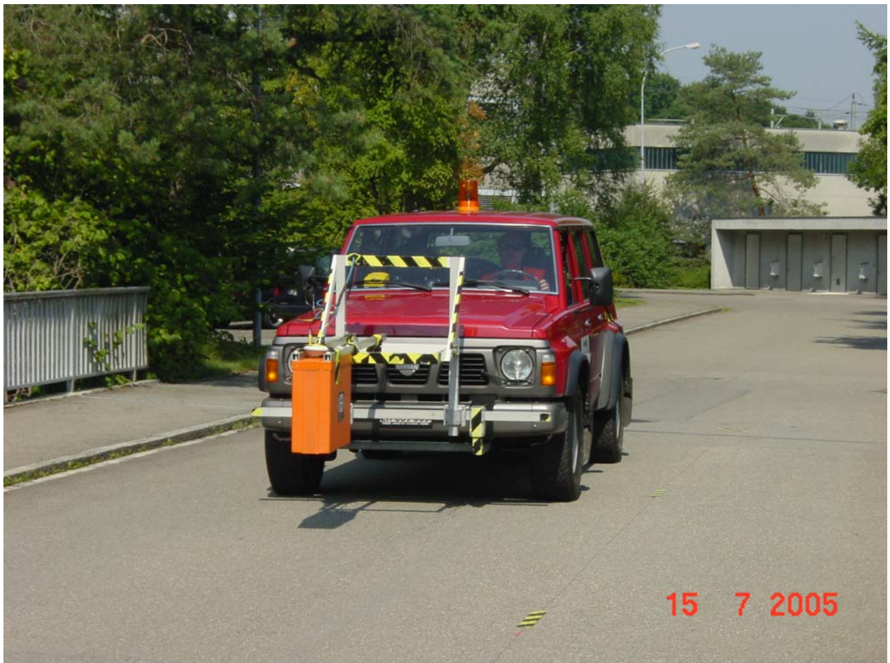
Abbildung 7-1: Messfahrzeug mit GSSI Modell 4105 Antenne
