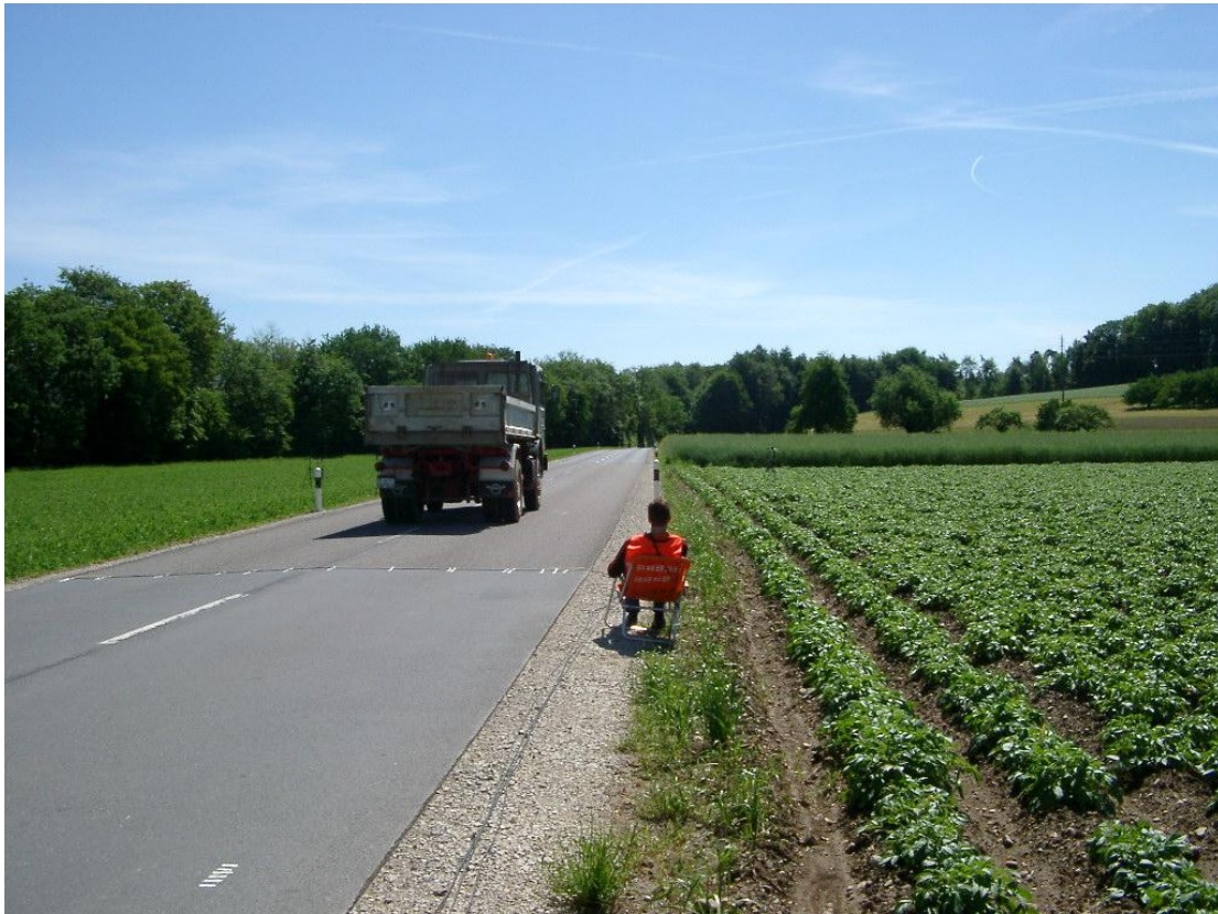
Bild 68: Geschwindigkeitsmessung jeder Vorbeifahrt
