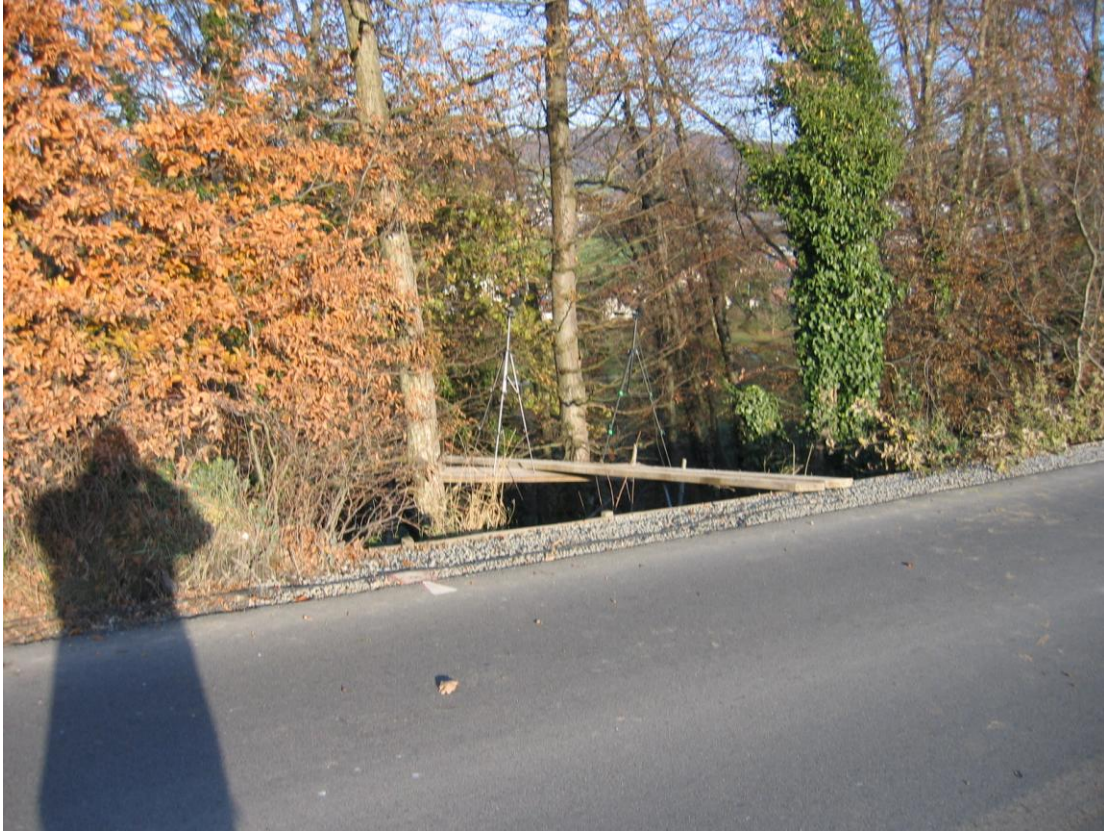
Bild 66: Konstruktion zur Aufstellung der Mikrofone im Abstand von 7.5 m ab Achse
