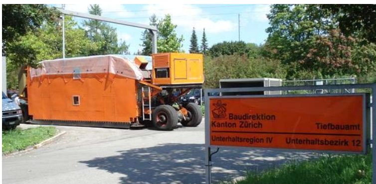
Abb. 4.28 Einfahren der MLS10 auf die Brückenwaage der Kantonspolizei Betzholz/Hinwil
