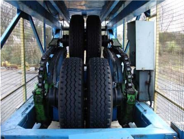
Abb. 4.9 Aufhängung der Belastungsräder mit Laufrädern, Schemel, Schiene des Schemels und Antriebskette
