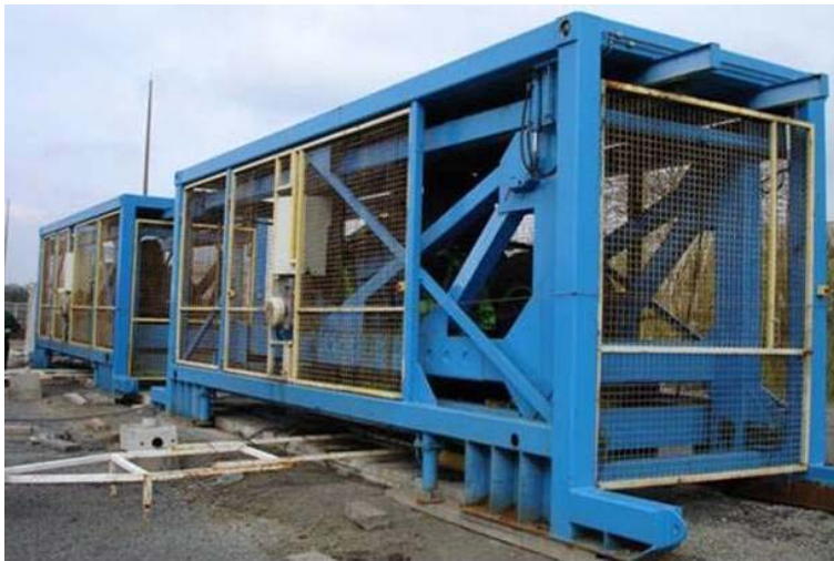
Abb. 4.7 Bild der beiden FABAC-Maschinen. Im Inneren befinden sich die vier Belastungsräder mit dem Tarierungs-Rahmen. Deutlich sichtbar sind die unter Strassen-niveau tiefer gesetzten Gleitkufen.
