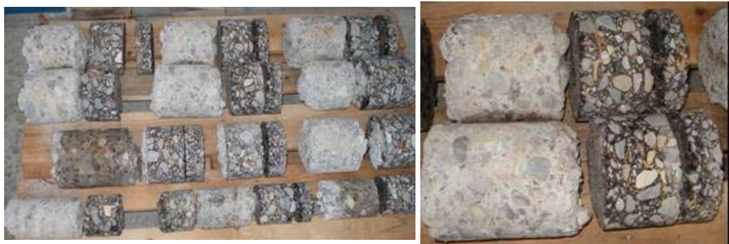
Abb. 4.24 links: Bohrkern hinter der Simulatorposition 1 in Rollachse entnommen; rechts: Details der Bohrkern 2 (oben) und 5 (unten)
