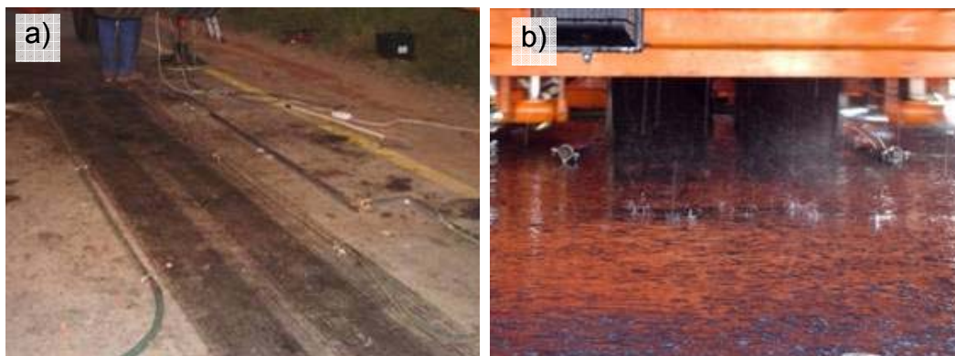
Abb. 4.13 nasse Prüfung: a) Installation der Wassersprüher, b) Überrollvorgang
