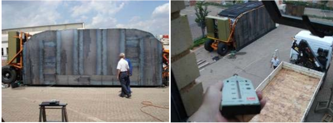
Abb. 4.18 links: Messung in Messachse D in 7.5m Entfernung; rechts: Messung aus dem zweiten Stock des Werksgebäudes
