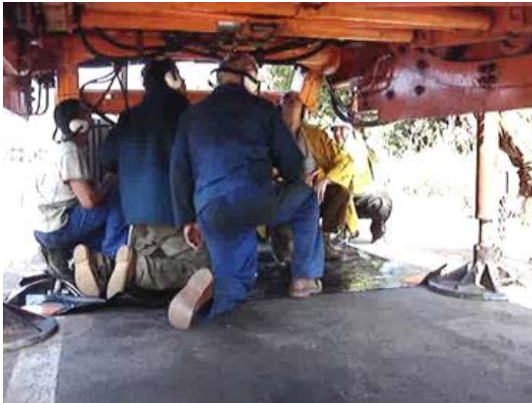
Abb. 4.14 Wartung durch Mechaniker (Hydraulik für den Radanpressdruck) im Arbeitsraum unter der ca. 1m hydraulisch angehobenen und durch feste Stahlstützen gesicherten Maschine
