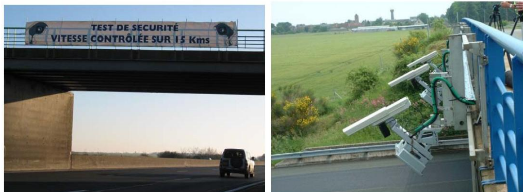
Abbildung 10: Ankündigung der Durchschnittsmessung und Erfassungskameras 14
