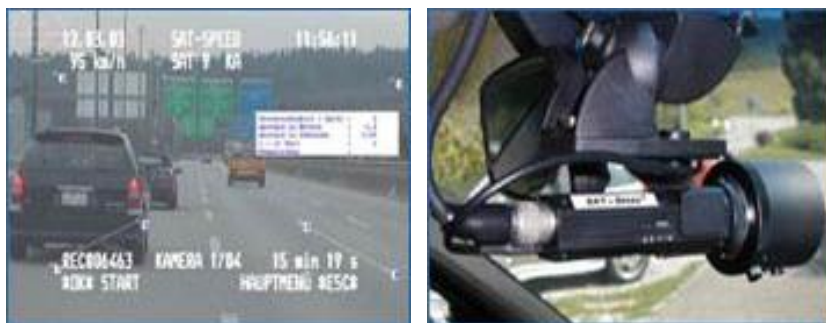
Abbildung 32: Beispiel einer Nachfahrkontrolle, Kamera hinter Windschutzscheibe 47
