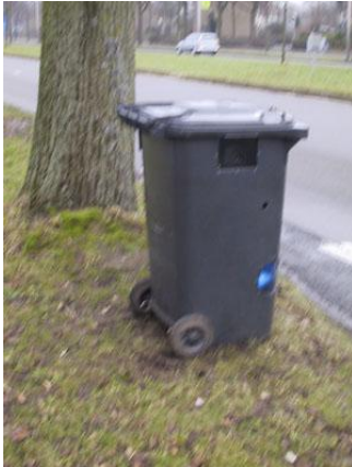
Abbildung 16: Beispiel für eine versteckte, portable automatische Punktkontrolle 24
