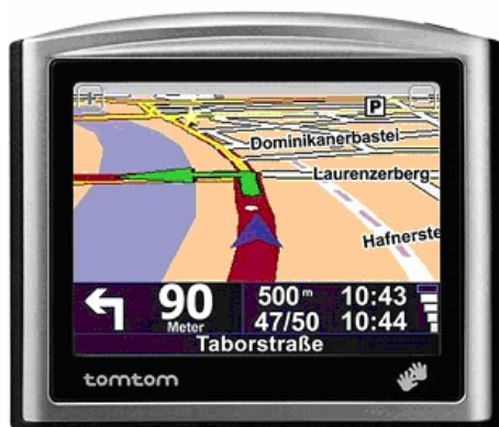
Abbildung 37: TomTom-Gerät mit Tempolimit und der aktuellen Geschwindigkeit 58
