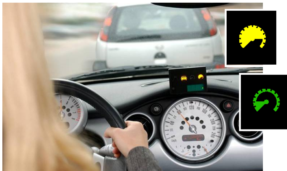
Abbildung 42: Belonitor-Fahrzeuggerät, Anzeige für zu schnelles und korrektes Fahren 71
