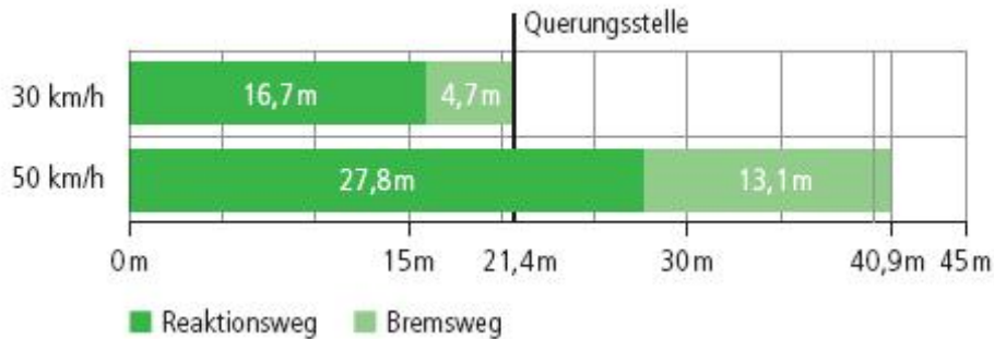
Abbildung 3: Anhalteweg bei trockener Fahrbahn 7
