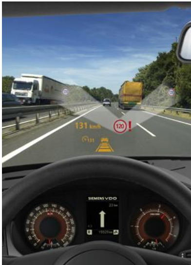
Abbildung 50: Siemens „Traffic Sign Recognition“ System 98
