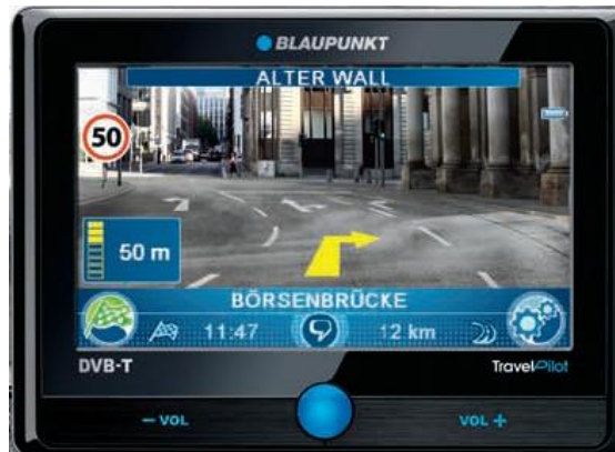
Abbildung 38: Blaupunkt-Gerät mit videobasierter Verkehrsschilderkennung 60
