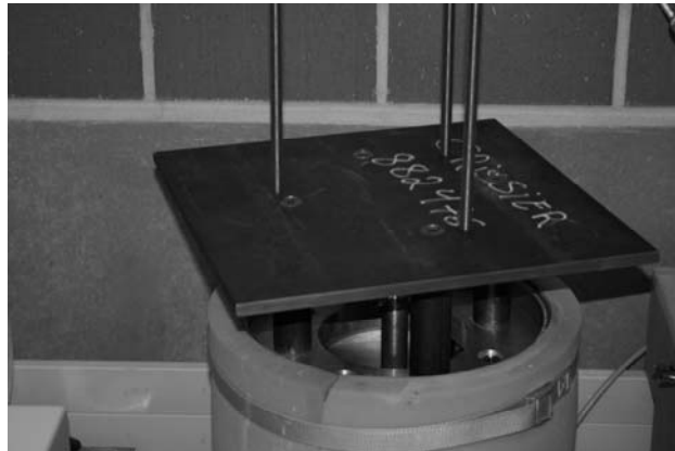
Figure 34 : Installation du plateau de chargement au sommet du piston
