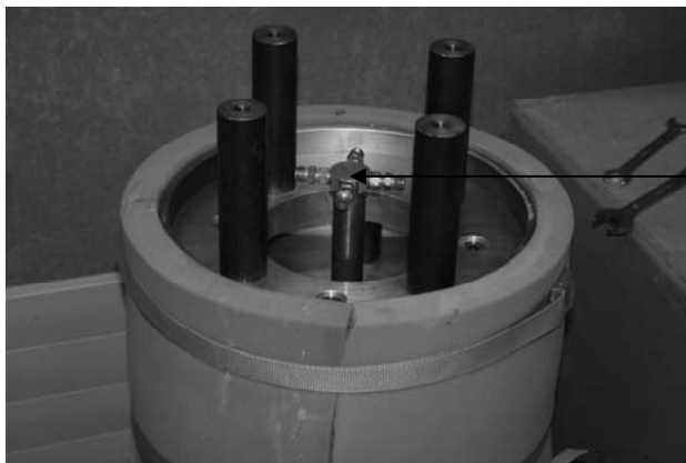
Figure 33 : Mise en place du système de chauffage
