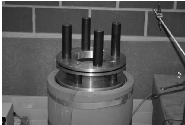
Figure 32 : Installation du piston au sommet de la cellule
