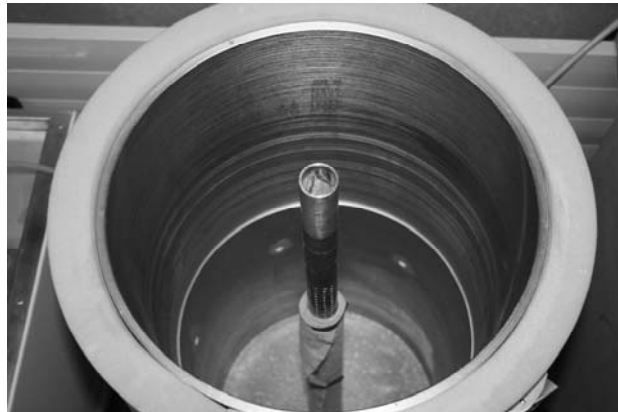
Figure 30 : Drain central installé dans la cellule
