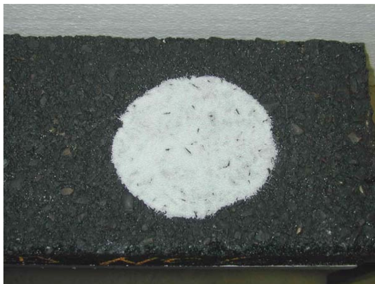
Figure 7 - Mesurage de la profondeur de macrotecture avec billes de verre calibrées
