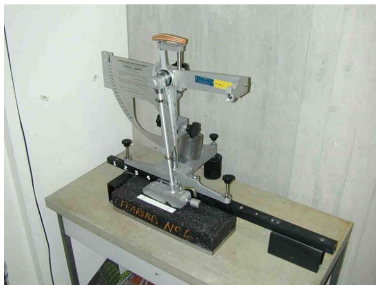
Figure 8 - Support spécial avec pendule SRT pour mesure de la qualité antidérapante
