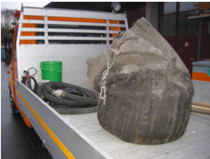
Abbildung 73: Die Geotextilsäcke wurden aus den Versickerungsschächten herausgezogen und in den Werkhof transportiert für die Entnahme von Schlammproben und zum Wägen des Sackinhalts.
