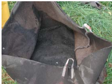
Abbildung 9: Auf der Innenseite des Geotextilsacks baut sich eine Schicht aus feinsten Partikeln auf.
