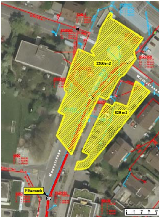
Abbildung 100: Perimeter des Einzugsgebietes des Schachtes in der Moosstrasse
