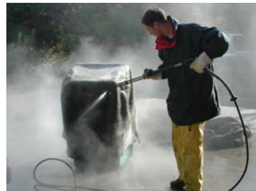
Abbildung 10: Geotextilsäcke können mit Hochdruck gereinigt und wieder eingesetzt werden.
