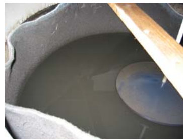
Abbildung 8: Ein neuer Geotextilsack in der Filterkolonne von 1.00 m Durchmesser. Der Filter wurde eingestaut betrieben. Für zukünftige Anwendungen wird der Einsatz der Filter nicht eingestaut empfohlen, damit der Geotextilsack in Trockenzeiten austrocknen kann.
