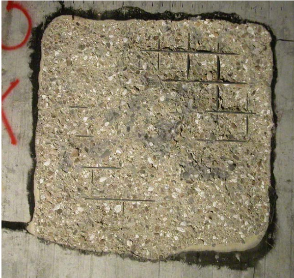
Abbildung 11: Prüfkörper Mix 2 mit d=150 mm nach der Brandprüfung
