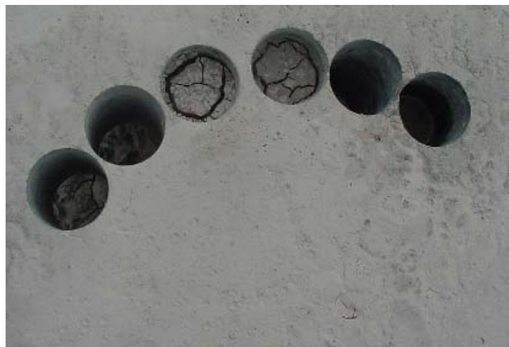
Abbildung 27: Probengewinnung durch Herausspitzen (li) und durch Bohrkernentnahme (re)
