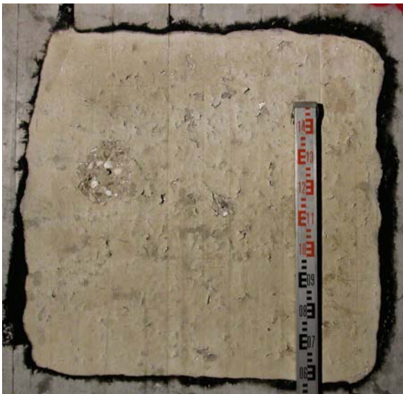
Abbildung 24: Prüfkörper Mix 4 mit d=350 mm nach der Brandprüfung
