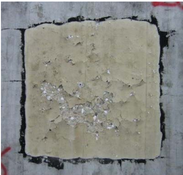
Abbildung 13: Prfkkrper Mix 3 mit d=150 mm nach der Brandprfung
