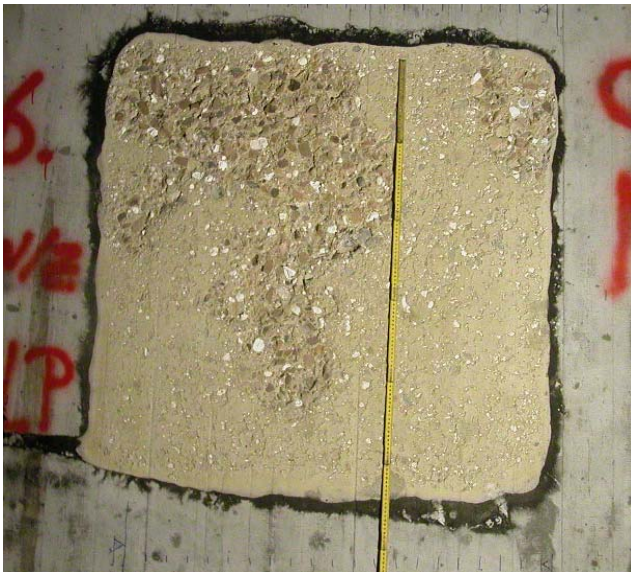
Abbildung 9: Prüfkörper Mix 1 mit d=150 mm nach der Brandprüfung
