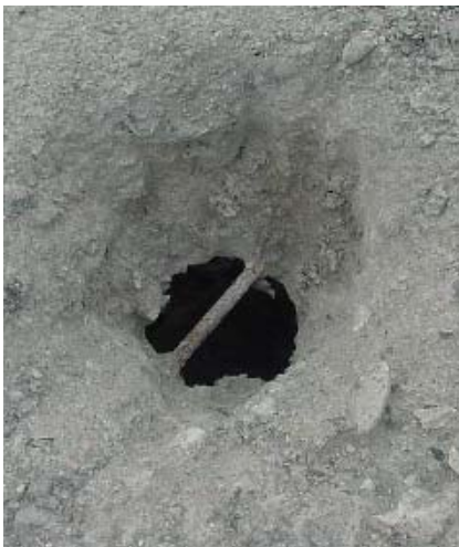
Abbildung 27: Probengewinnung durch Herausspitzen (li) und durch Bohrkernentnahme (re)
