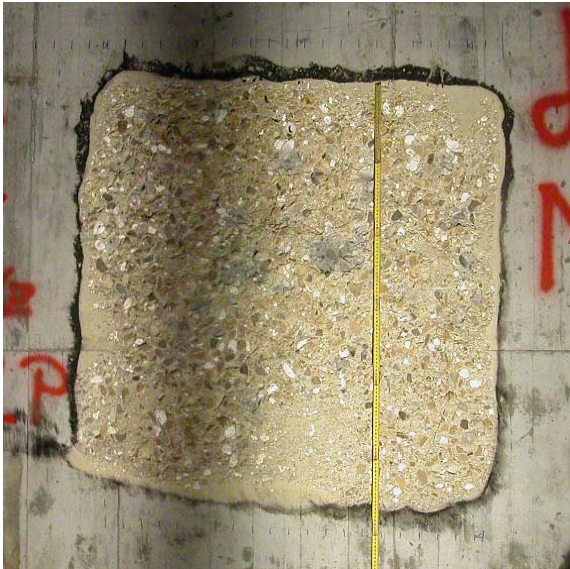
Abbildung 18: Prüfkörper Mix 1 mit d=350 mm nach der Brandprüfung
