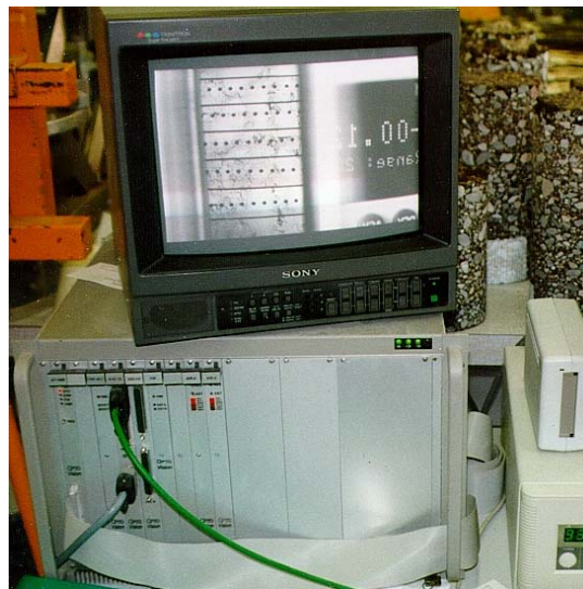
Abbildung 6.4.2: Schema Versuchsaufbau Abbildung 6.4.3: Bildverarbeitungssystem mit Monitor und Frame Grabber
