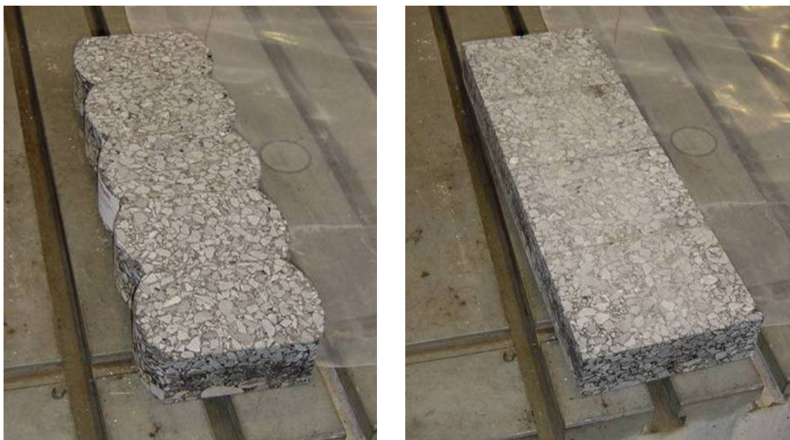
Abbildung 6.3 Vergleichsversuche an SAM Bohrkernen: Zusammengesetzte Prüfkörper.
