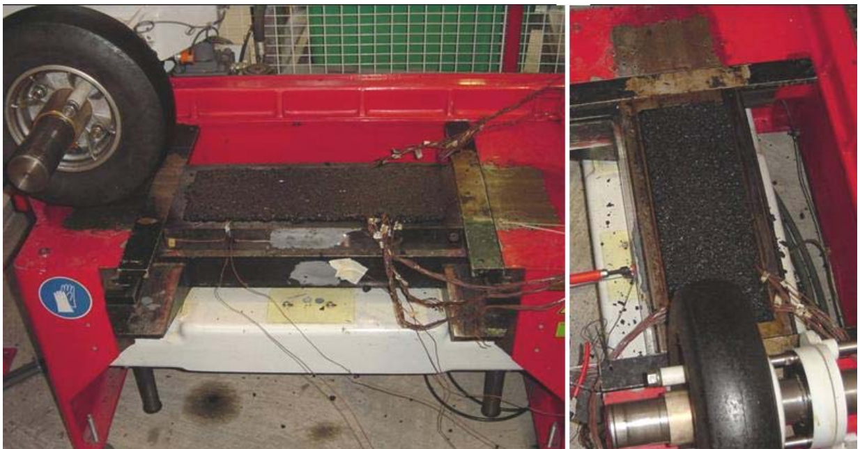
Abbildung 6.54 Zustand nach dem Verdichten
