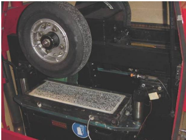
Abbildung 5.1 Prüfeinrichtungen: (a) – LCPC-Spurbildungstester (Orniéreur); (b) – LCPC-Verdichter (BBPAC).
