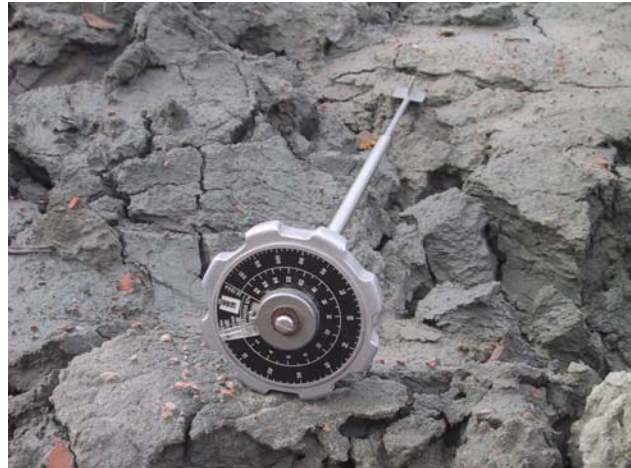
Abb. 4.38: Schema der Drehflügelsonde [6]. Im Bild: Pilcon Drehflügelsonde
