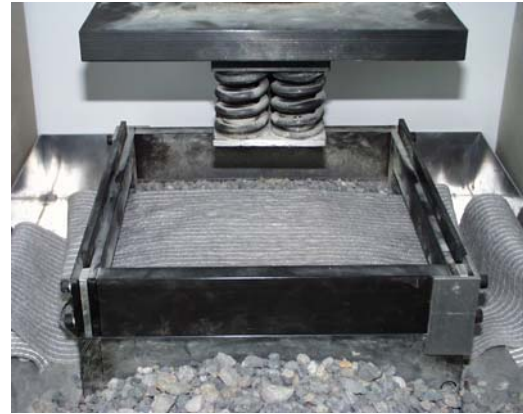
Abb. 4.30: Einbau der Geokunststoff-Probe
