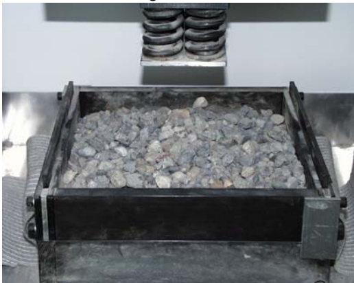
Abb. 4.31: Einbringen der oberen Bodenschicht
