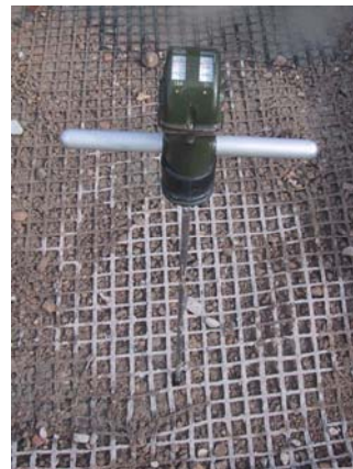
Abb. 4.41: CBR-Penetrometer nach [125]: Eine Nadel mit definierter Kegelspitze (Öffnungswinkel 60^\circ , Grundfläche 10 \text{ cm}^2 ) wird mit 20 \text{ mm s}^{-1} in den Untergrund eingedrückt und der Eindringwiderstand gemessen. Eine kalibrierte Skalentrommel erlaubt die direkte Ablesung des CBR-Koeffizienten in %
