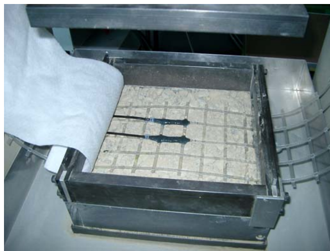
Abb. 4.81: Einbausimulation nach [117] an mit Dehnungsmessstreifen bestückten Proben
