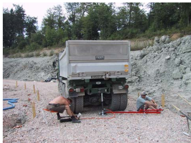
Abb. 4.49: Statischer Plattendruckversuch [6]: Eine kreisrunde Platte wird mit zunehmender Normalspannung belastet. Gemessen wird die Einsenkung
