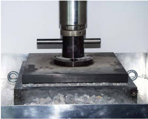
Abb. 4.29: Verdichtung der unteren Bodenschicht
