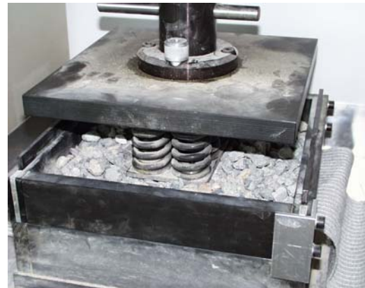
Abb. 4.32: Zyklische Belastung des Prüfaufbaus
