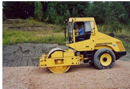
Abb. 4.65: Flächendeckende Dynamische Verdichtungskontrolle FDVK (Bomag)
