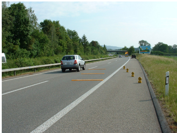
Abbildung 15: Blitzlichter auf der Höhe der Warnschwellen bei neuer Versuchsanordnung an der Tagesbaustelle A7-Attikon
