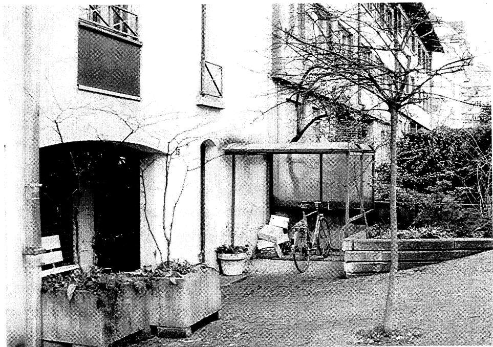
Abb. 7-12: Zweiradabstellanlage zum Kurzzeitabstellen – eingangsnah, ebenerdig, überdacht und gestalterisch gelungen (Vorbehalt: Vorderradhalter sind ungeeignet)
