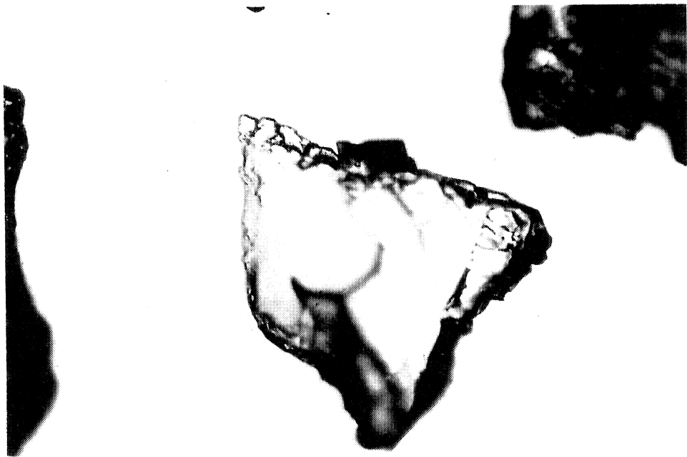
Abbildung 18 Detailaufnahme eines "roten" Korundkorns im Anlieferungszustand. Die Kanten des Korundkorns erscheinen sehr eckig und weisen ausserdem Bruchflächen auf (Mahlprozess). (EMPA-Foto Nr. 99203/24)
