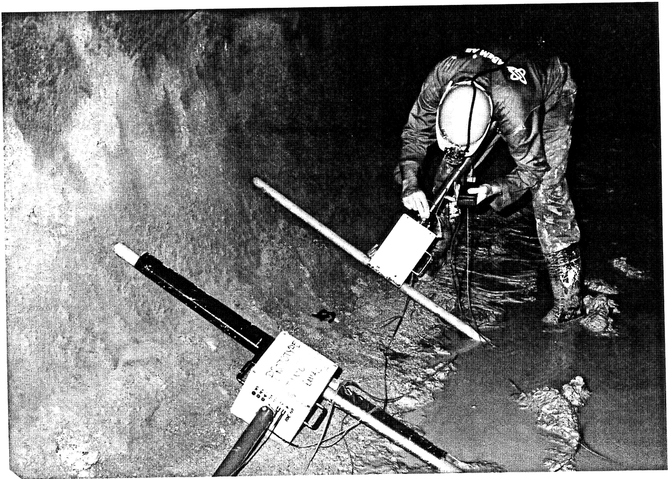
Bild 25 Testmessungen mit Georadar im Umfahrungstunnel Wattwil. Einsatz der Dipolantennen in der Sohle des Pilotstollens bei einem Antennenabstand von 2 m.
