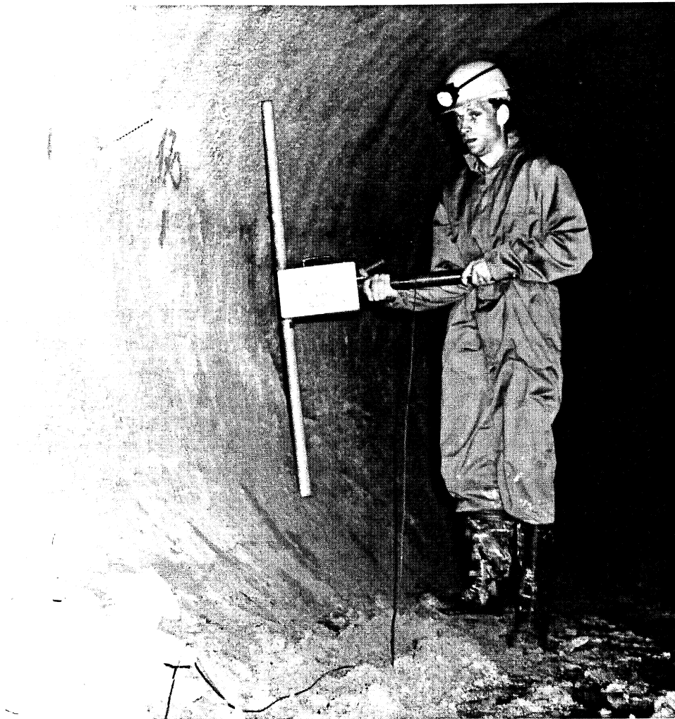
Bild 23 Testmessungen mit Georadar im Umfahrungstunnel Wattwil. Einsatz einer Dipolantenne in der Ulme des Pilotstollens nach der "Offset Profiling" Methode
