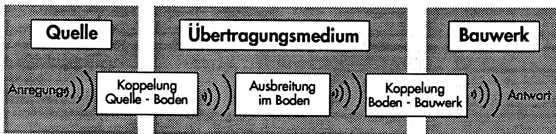
Fig. 2.14, Einfache Modellvorstellung der Erschütterungsausbreitung
