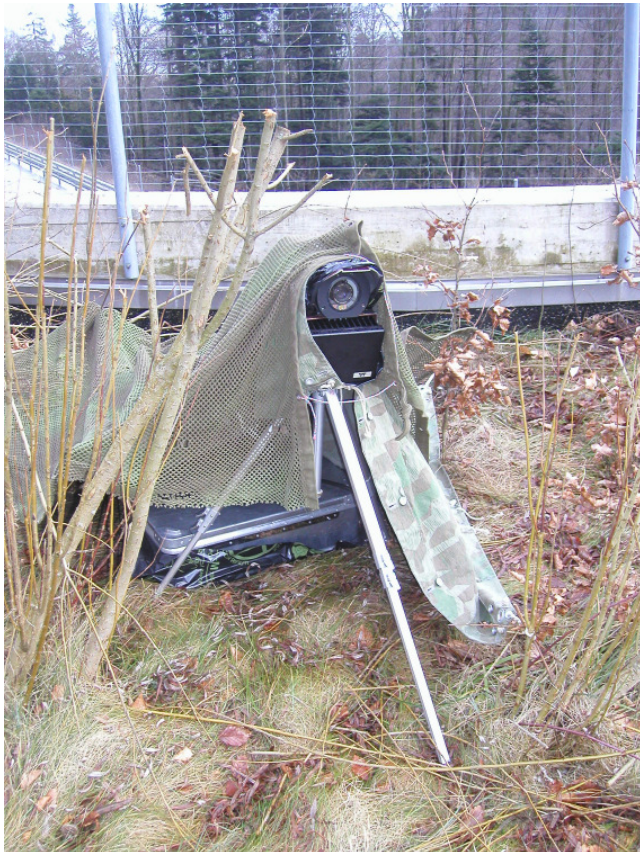
Abbildung 30: Beim Bachdurchlass bei Brienzwiler zum Einsatz gekommenes Infrarot-Videogerät
