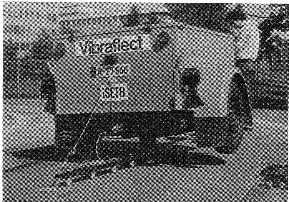
Vibraflect Schwinger ISETH in Arbeitsstellung. Das ganze Gewicht des Gerätes ruht auf dem Stempel. Im Vordergrund 4 Geophone zur Ausmes- sung der Deflektionsmulde.
