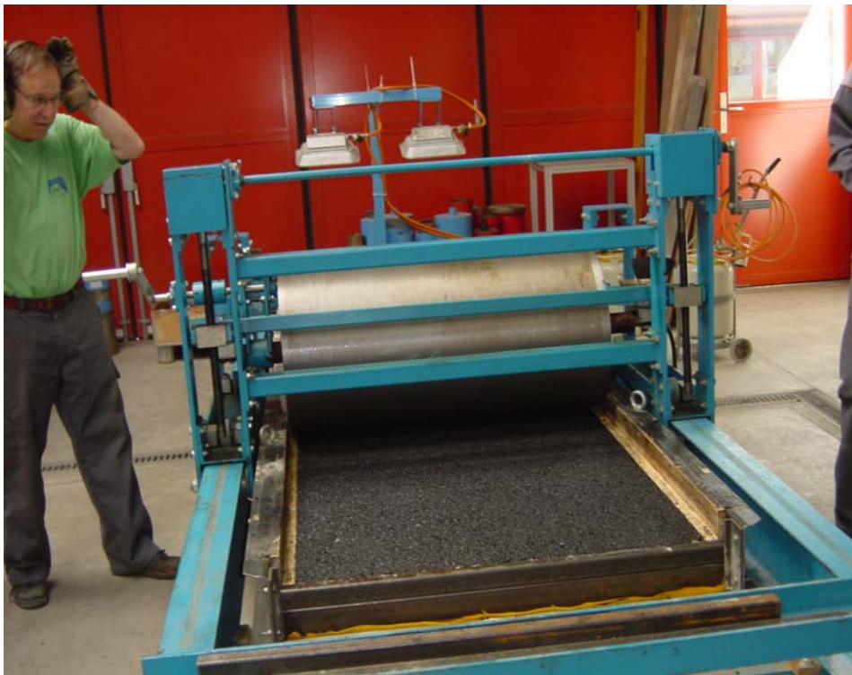
Abbildung 8.1.2: MLS Verdichter mit Prüfkörper
