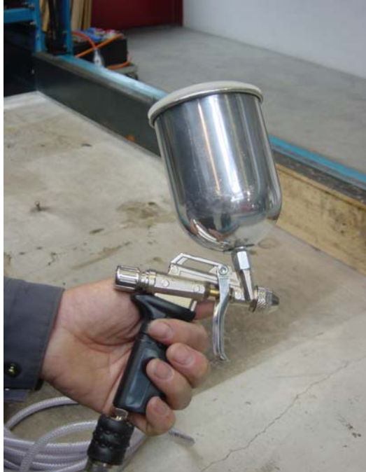
Abbildung 8.1.3.: Spritzpistole zum Aufsprühen des Haftvermittlers
