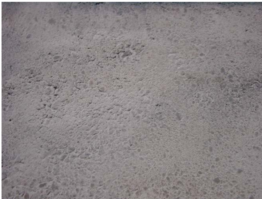
Abbildung 9.7.2: Platte 7 nach Aufbringen des Feinkorunds (Schmutz), Nahaufnahme
