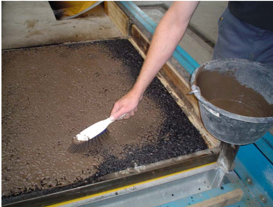
Abbildung 9.9.1: Platte 9 während des Aufbringens des mit Wasser gemischten Feinkorunds
