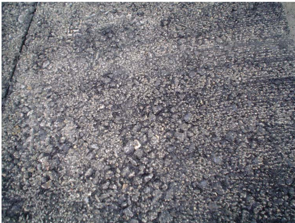
Abbildung 9.6.2: Oberfläche der Platte 5 und 6 nach dem Fräsen
