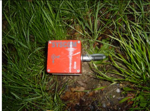
5. Beschleunigungssensor- Geophone keine Schäden - Sensor war mit einen neuen ersetzt
