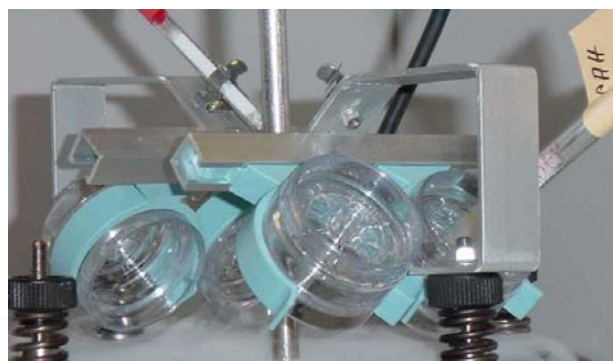
Abbildung 3: Schematische und fotografische Darstellung der Filteranordnung
