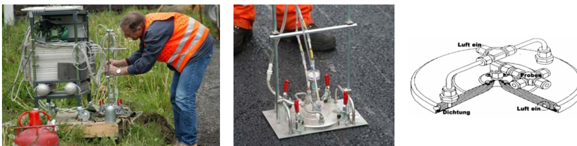
Abbildung 20: Beprobung der heissen Belagsoberfläche. Setup mit Volumensteuerung, Gasflaschen und Pumpen (links); Absaugung, Filter und Adsorptionsröhrchen (Mitte); Konzeptskizze der Flec Zelle (rechts).
