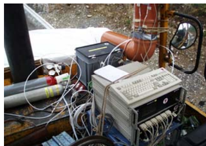
Abbildung 22: Umgebauter Fertiger in Wiggertal (links), Einrichtung für \text{SF}_6 Zudosierung und Absaugung (rechts).
