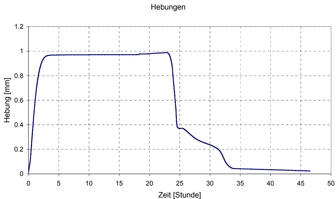
Bild 93 Hebungen während dem Frostversuch
