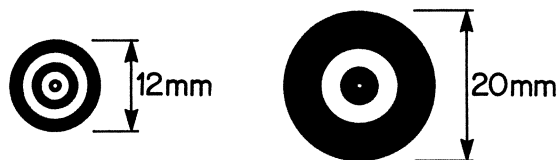
Bild 6.7 Zielpunkte im Massstab 1:1 zur genauen Auswertung der Messbilder
