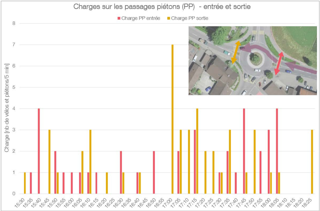
Fig. 121 Charges de piétons et vélos sur les traversées piétonnes en entrée et sortie de giratoire
