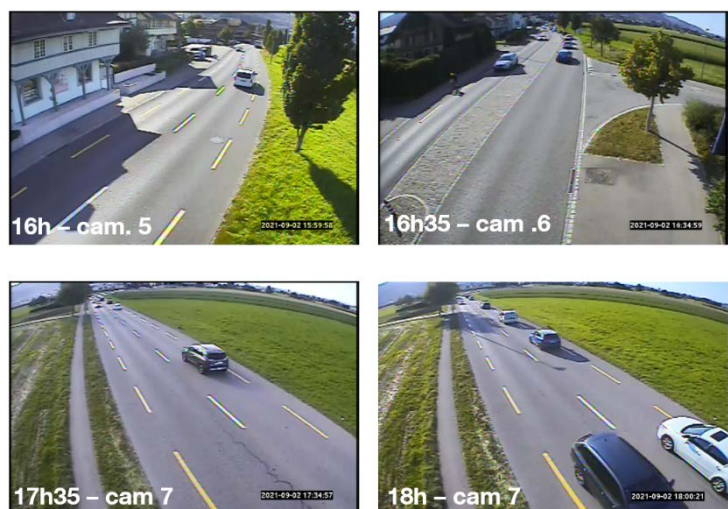
Fig. 132 Estimation des longueurs de files d'attente par observation croisée des différentes vidéos
