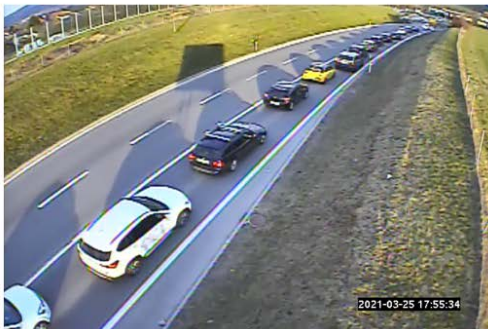
Fig. 96 Observations vidéo des files d'attente sur la branche ouest et comparaison avec les résultats des calculs théoriques adaptés aux cas de blocage
