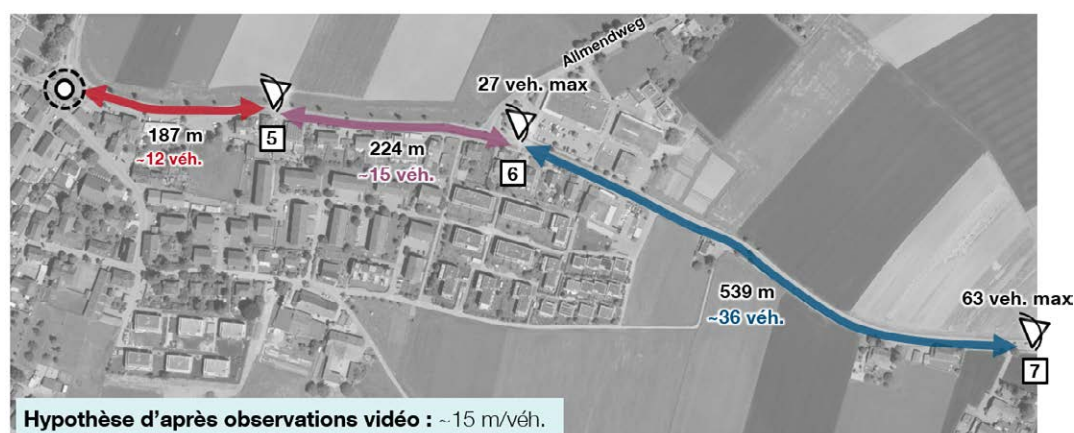
Fig. 126 Tronçons étudiés en amont du giratoire, distance et position des caméras
