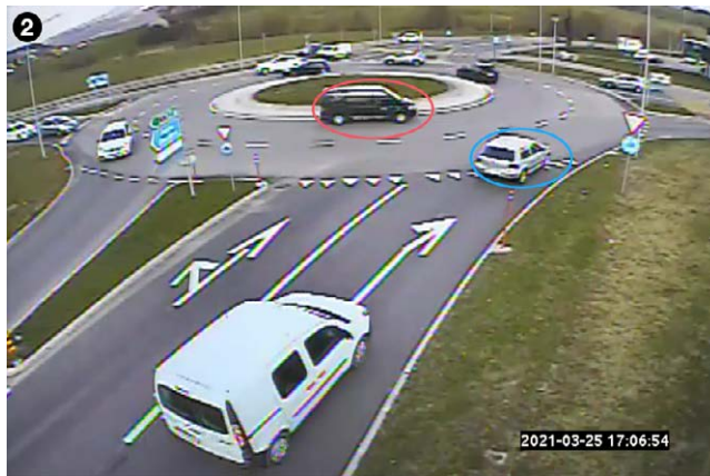
Fig. 88 Observation d'un cas où le flux de l'anneau intérieur ne gêne pas l'insertion
