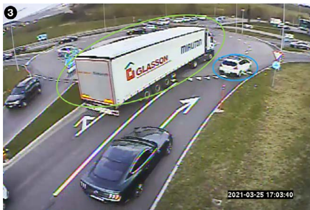
Fig. 89 Observation de l'effet protecteur des véhicules sur la voie de gauche
