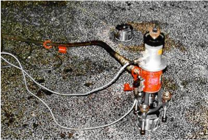
Abbildung 5.1: Vorrichtung für Haftzugprüfung in situ, hier mit Prüfkörperdurchmesser von 50 mm
