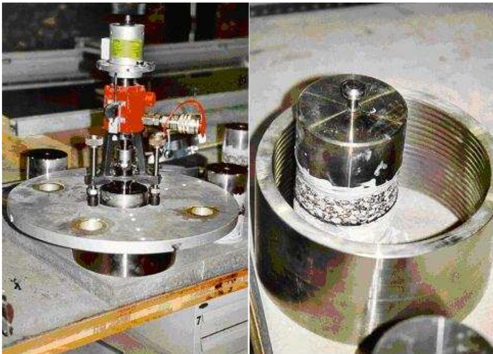
Abbildung 5.2: Vorrichtung für Haftzugprüfung an Bohrkernen
