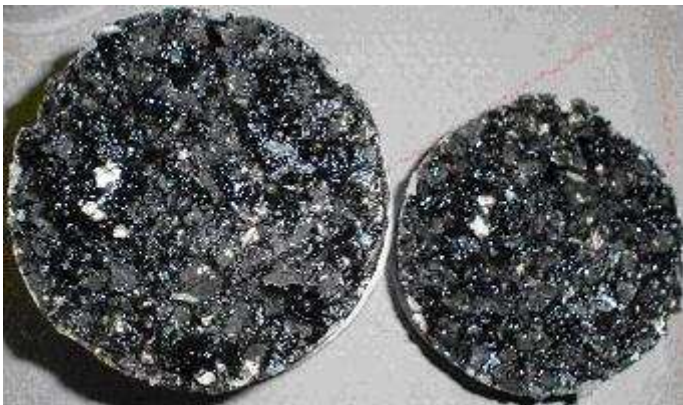
Abbildung 5.14: Bruchbilder der Haftzugprüfung an Bohrkern aus Feld 1
