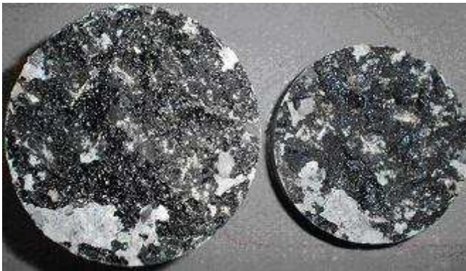
Abbildung 5.18: Bruchbilder der Haftzugprüfung an Bohrkern aus Feld 5
