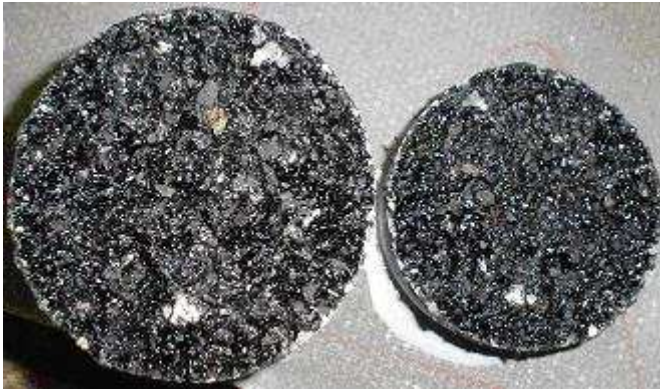
Abbildung 5.16: Bruchbilder der Haftzugprüfung an Bohrkern aus Feld 3
