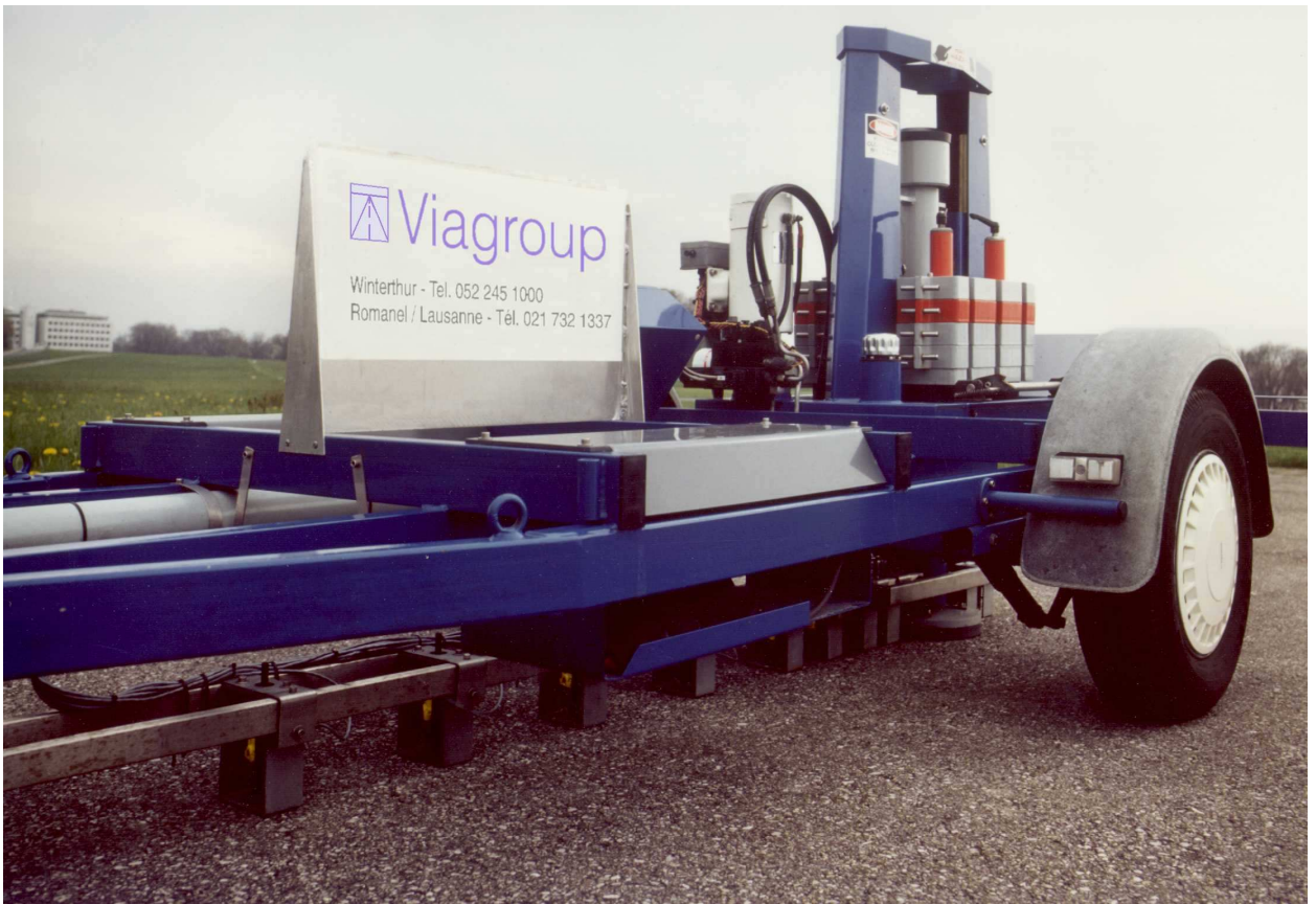
Abbildung 4.2: FWD-Gerät Dynatest 8000 in Messaufstellung (Sensoren auf der Belags- oberfläche abgesetzt).
