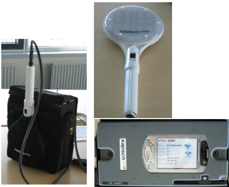
Abbildung 6-7: Ausrüstung der Polizeikontrolleure bei der LKW-Maut Österreich
