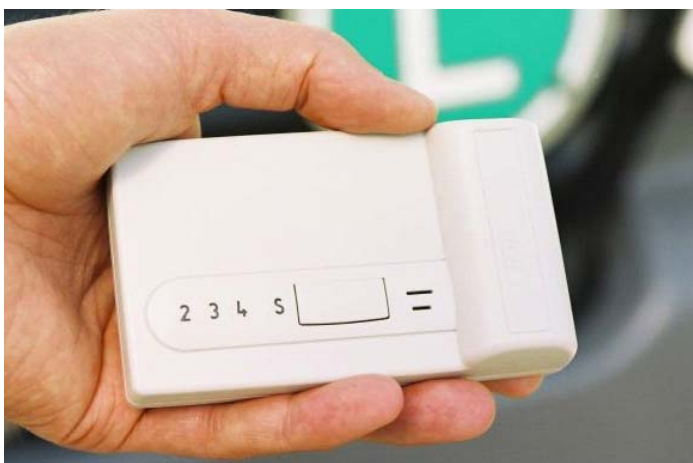
Abbildung 6-3: Go-Box (OBU für die LKW-Maut in Österreich)
