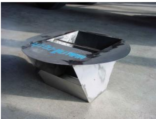
Amphibiensyphon der Firma Nill Metallbau AG (Winterthur). Der rutschfeste Ausstieg für die Amphibien (dunkle Fläche) zeigt nach hinten, vorne im Bild ist der Ausgang für das Wasser zu sehen.
