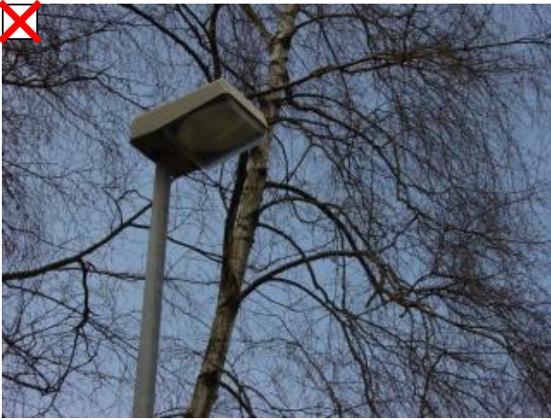
Auch dieses Modell erfüllt die strengen Full-Cutoff-Kriterien wohl nicht vollumfänglich.
