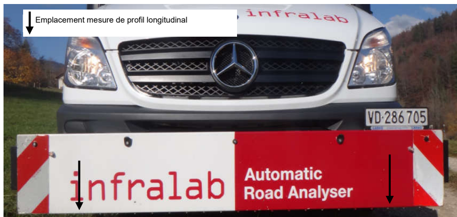
Fig. 15 – Emplacement des capteurs de mesures de planéité longitudinale
