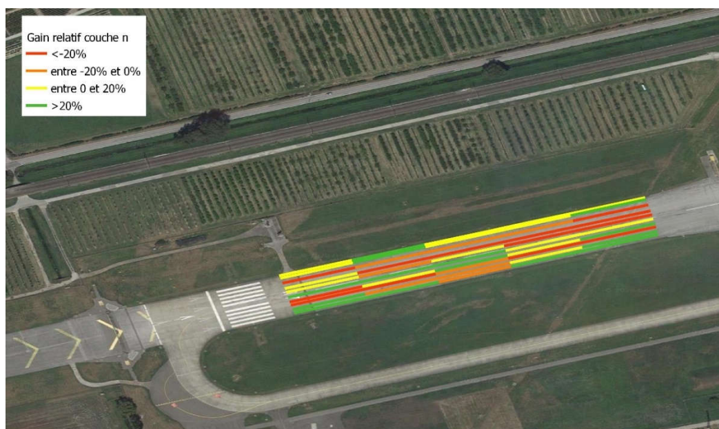
Fig. 31 – Cartographie des gains relatifs s_{w50} sur la piste de Sion
