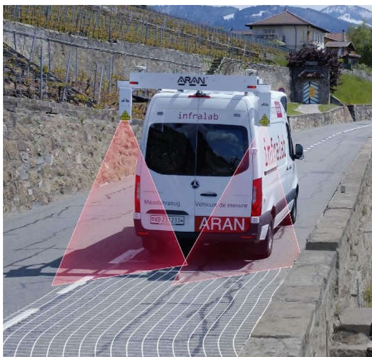
Fig. 16 – ARAN équipé de capteurs LCMS
