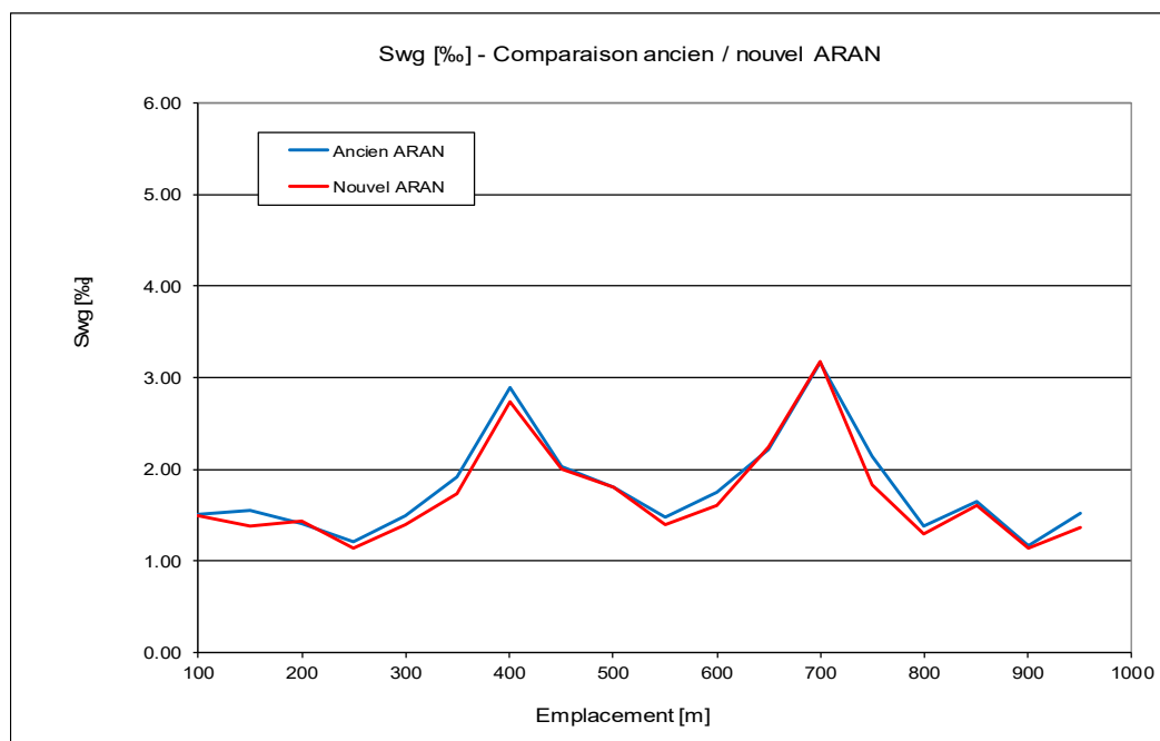
Fig. 17 – Valeur s_w dans la trace de roue gauche
