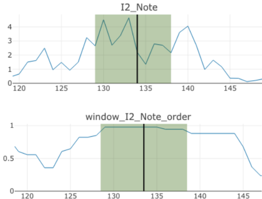
Fig. 16 : Illustration de la démarche de propagation du mauvais état avec un percentile considérant les données sur une fenêtre de +/- 250m, puis de normalisation des résultats.
