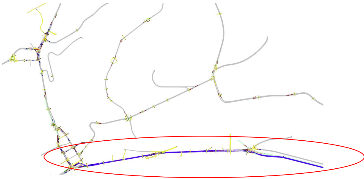
Abb.11 Verkehrsflusssimulationsmodell mit dem Analyseperimeter (blauer Strassenzug) der Stadt Luzern
