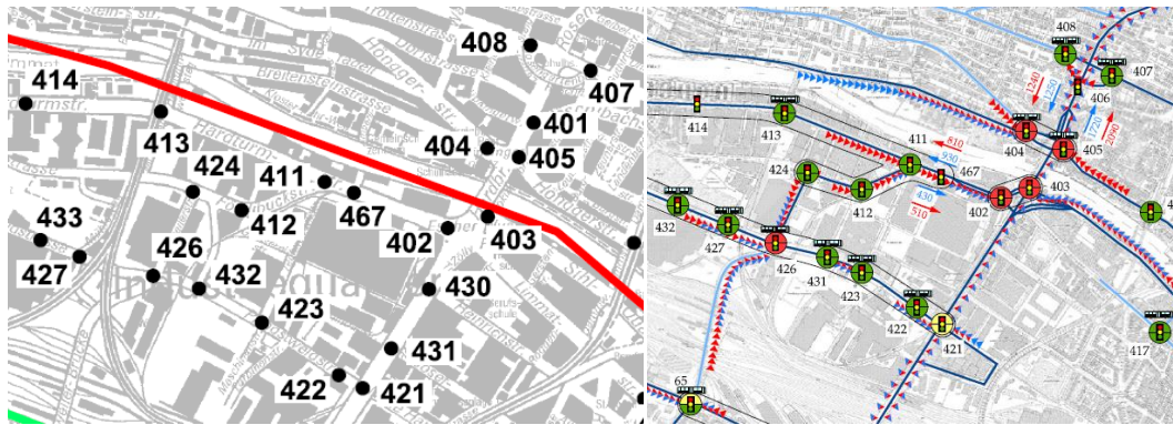
Abb.17 Knotennummern der per LSA geregelten Knoten (links), Auslastung der Knoten gemäss Layer Kenngrössen Verkehrsmanagement (rechts) (Quellen: DAV)
