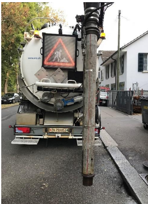
Abb. 4: ERZ-Saugwagen mit Saugrüssel
