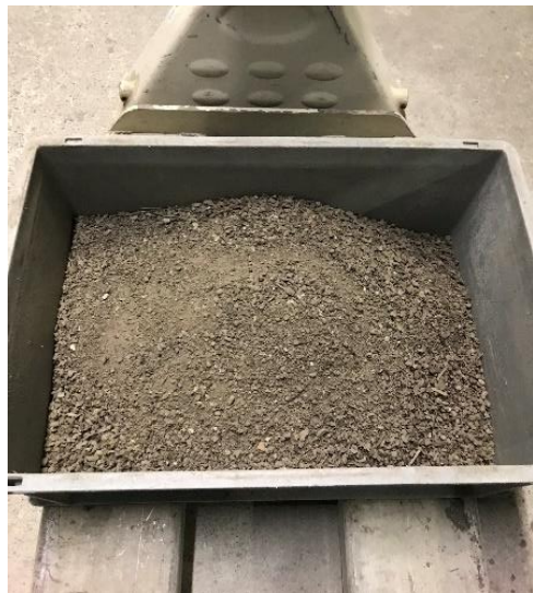
Abb. 10: Schlamm getrocknet und gesiebt bei 8 mm
