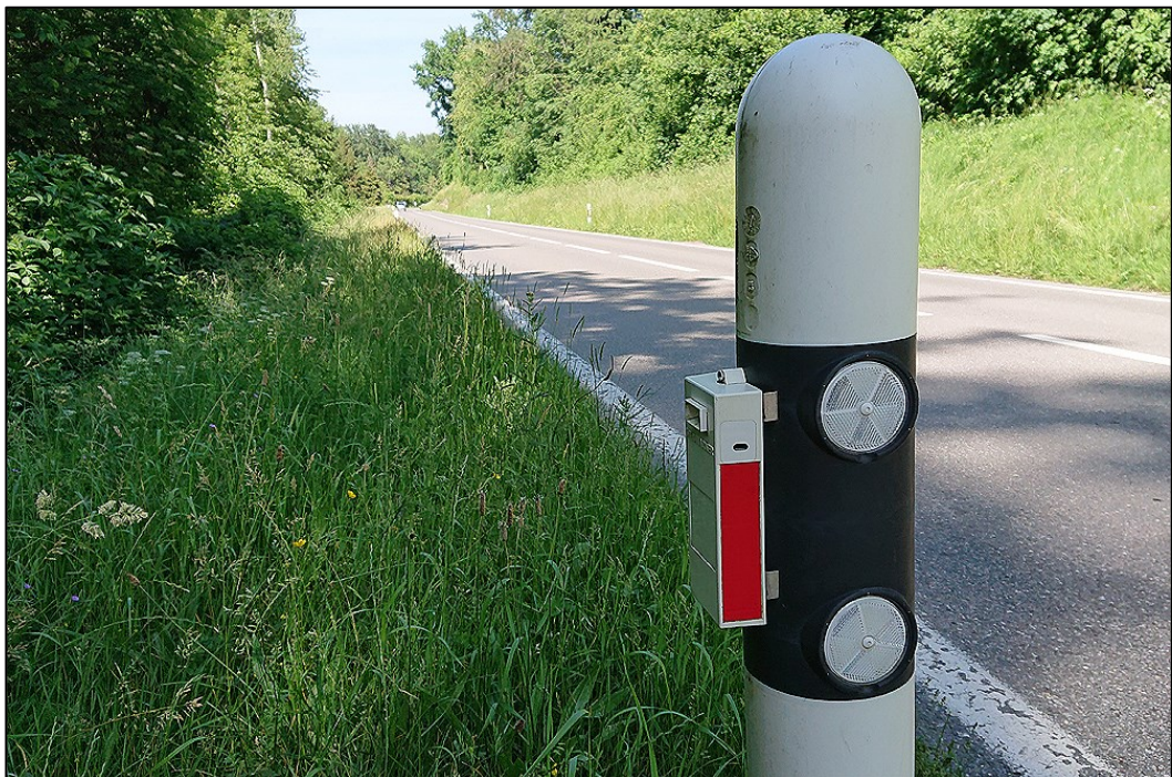
Abb. 20: Akustische Wildwarner werden an Leitpfosten angebracht und durch das Licht eines sich nähernden Fahrzeugs ausgelöst. Die Geräte geben einen Pfeifton ab, der verhindern soll, dass die Wildtiere die Strasse überqueren. © WLS.CH
