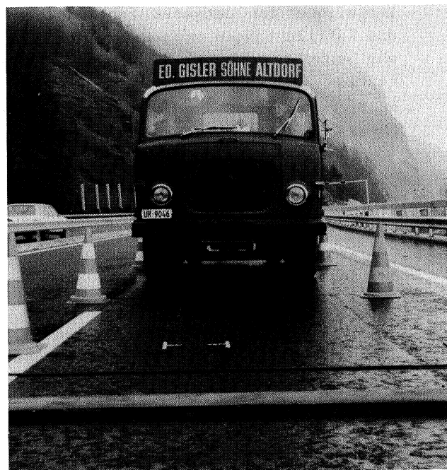
Bild 1: Dynamischer Belastungsversuch mit einem zweiachsigen Lastwagen.
