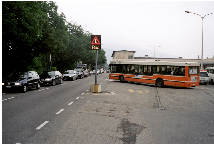
Abbildung 12: Bahnhof Olten Einfache Massnahme (auf Anmeldung) zur Busbevorzugung auf der Basis der Toleranz
