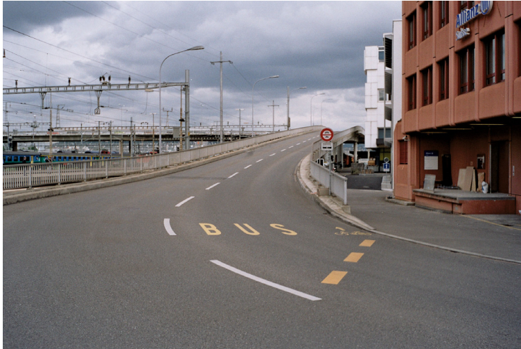
Abbildung 3: Busrampe am Bahnhof Altstetten, Beispiel einer gelungenen wirtschaftlichen Busbevorzugungsmassnahme: gutes Kosten/Nutzen-Verhältnis Direkte Busverbindung zur S-Bahn Fahrzeitgewinn 1.5 bis 5 Min. pro Richtung
