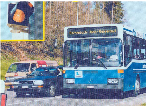
Ein weisses Licht für den Bus als Erlaubnis auf der Gegenfahrbahn zu fahren, auf eigene Verantwortung
