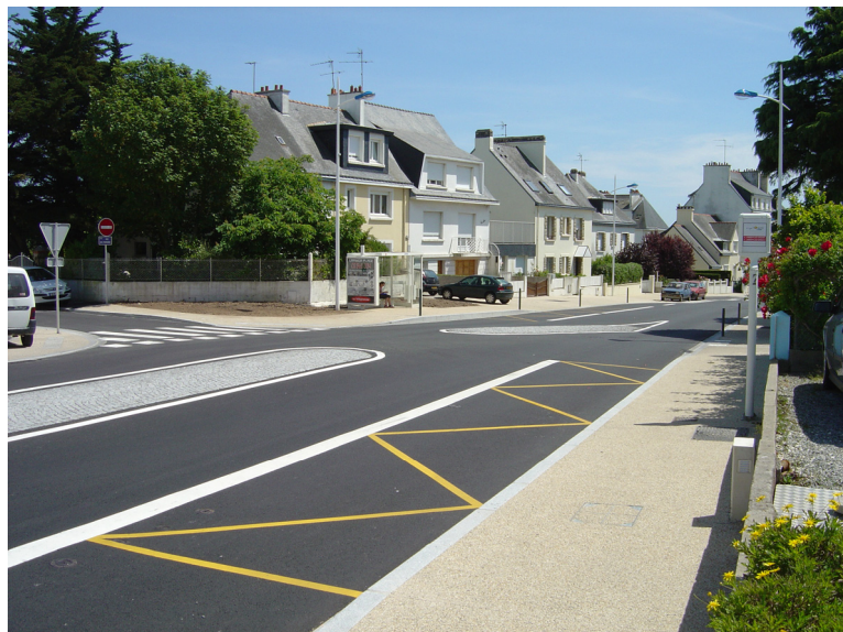
Abbildung 10: Entschleunigte MIV-Überholmanöver in Larmor-Plage (Lorient F) Kombination von Mehrzweckstreifen, überschleppbarer Mittelinsel und Fahrbahnversatz für den MIV
