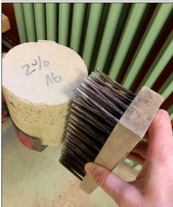
Abb. 2 Abbürsten eines Prüfkörpers. Alle Labors hatten die gleiche Bürste verwendet.
