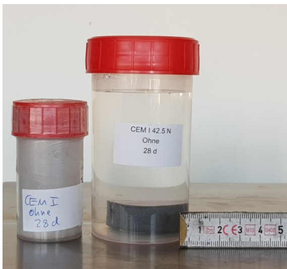
Abb.3 Plastikgefäss gefüllt mit Zementpaste (links); in 5%iger Natriumsulfatlösung eingelagerter Zylinder (rechts).
