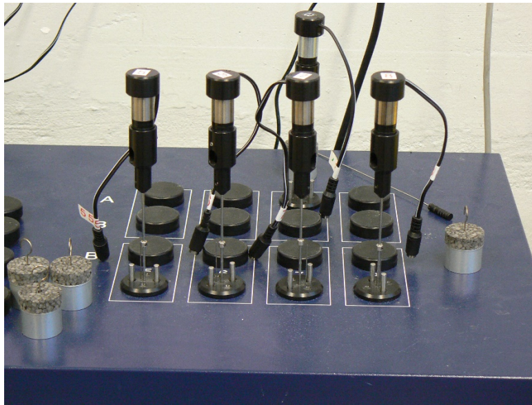
Abb.7 Wärmeflusskalorimeter TAM Air mit eingebauten Admix-Ampullen (links), Detail Admix-Ampulle (rechts).
