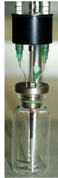
Abb.7 Wärmeflusskalorimeter TAM Air mit eingebauten Admix-Ampullen (links), Detail Admix-Ampulle (rechts).
