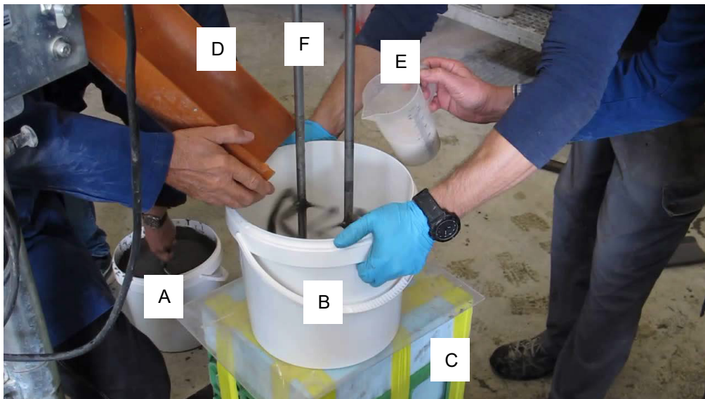
Abb.4 Herstellung von „Spritzbeton“: Füllen des ersten Kübels mit dem Bereitstellungsgemisch (A), Anschliessend Befüllung des zweiten Kübels (B) auf Podest (C) durch Entleerung des ersten Kübel über die Rutsche (D) unter Beigabe des Betonbeschleuniger in gewünschter Dosierung (E) bei gleichzeitiger Durchmischung mittels eines fest installierten Handrührwerk (F).
