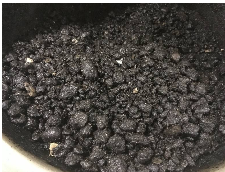
Fig. 4 Fabrication en laboratoire d'un mélange à froid avec émulsion de bitume pure.
