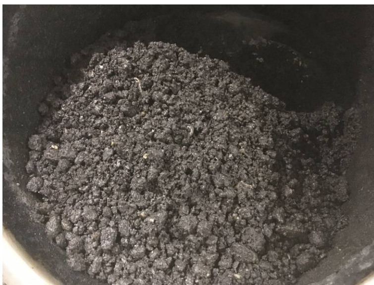
Fig. 9 Fabrication en laboratoire d'un mélange à froid avec émulsion de bitume pure et ciment (liant combiné).
