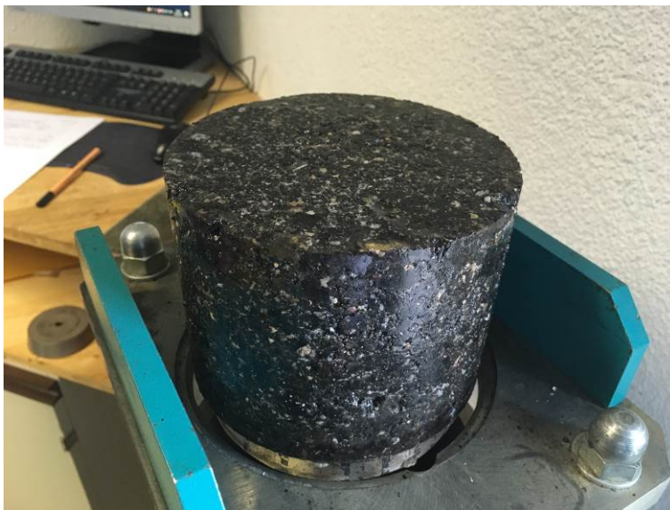
Fig. 16 Confection d'une éprouvette PCG d'un mélange à froid avec émulsion de bitume pure.
